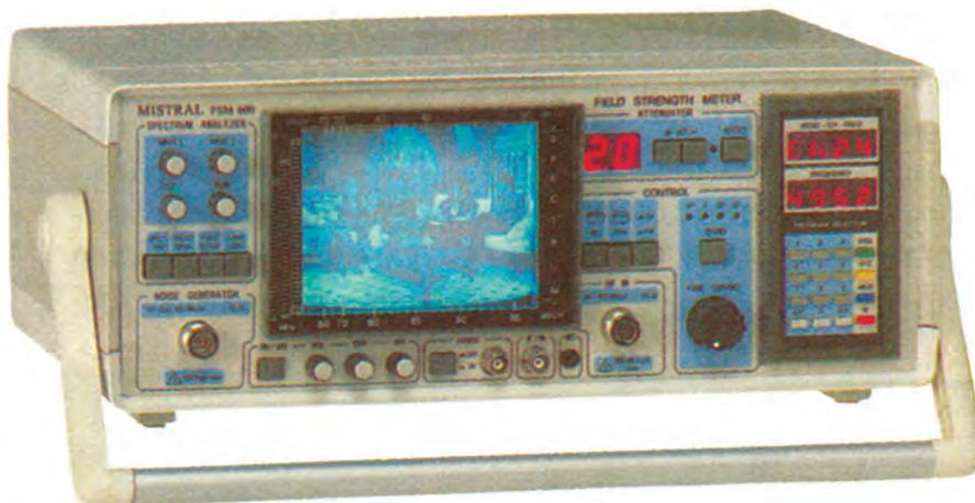
Σχήμα 10. Μετρητής πεδίου (πεδιάμετρο) έντασης.
