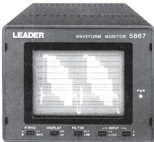
**Σχήμα 8.** Όργανο μέτρησης κυματομορφών (WAVEFORM MONITOR)
