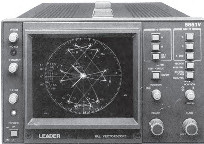
Σχήμα 9. Βέκτορσκοπ (VECTORSCOPE)
