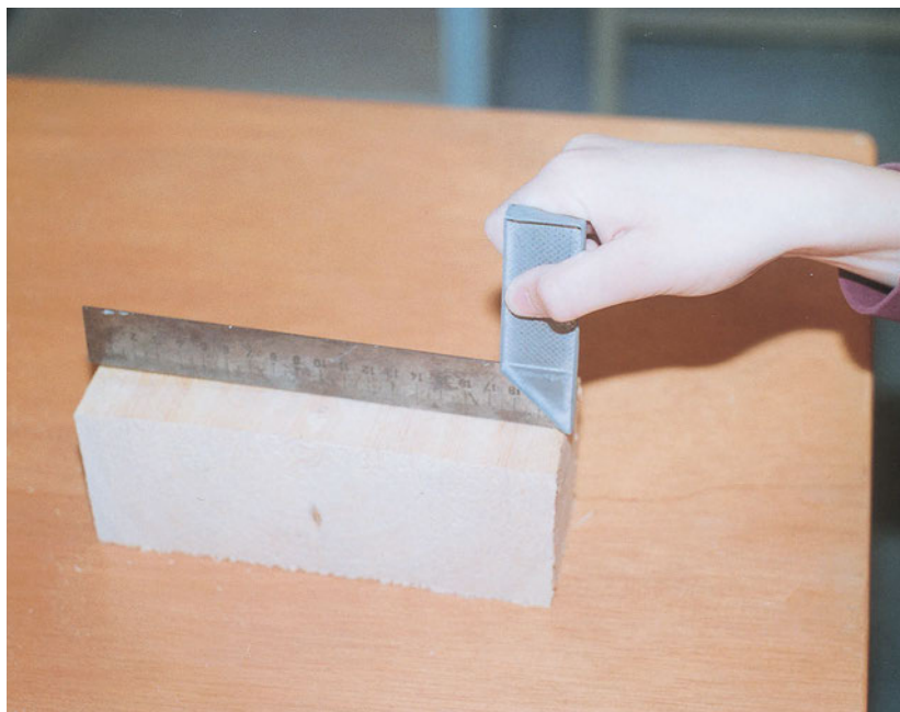
Εικόνα 4.10: Έλεγχος γωνιάσματος και επιπεδότητας.
