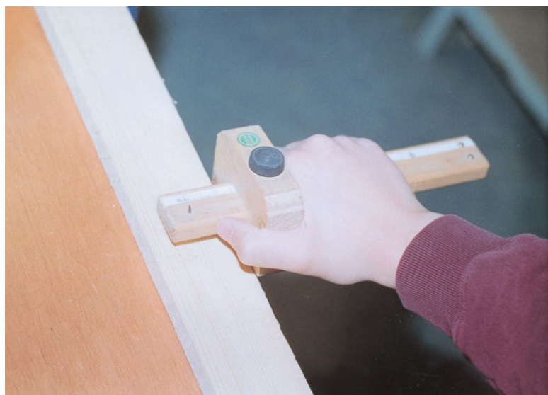
Εικόνα 4.12: Χάραξη ευθειών με τη βοήθεια σημαδούρας και γωνιάς.
