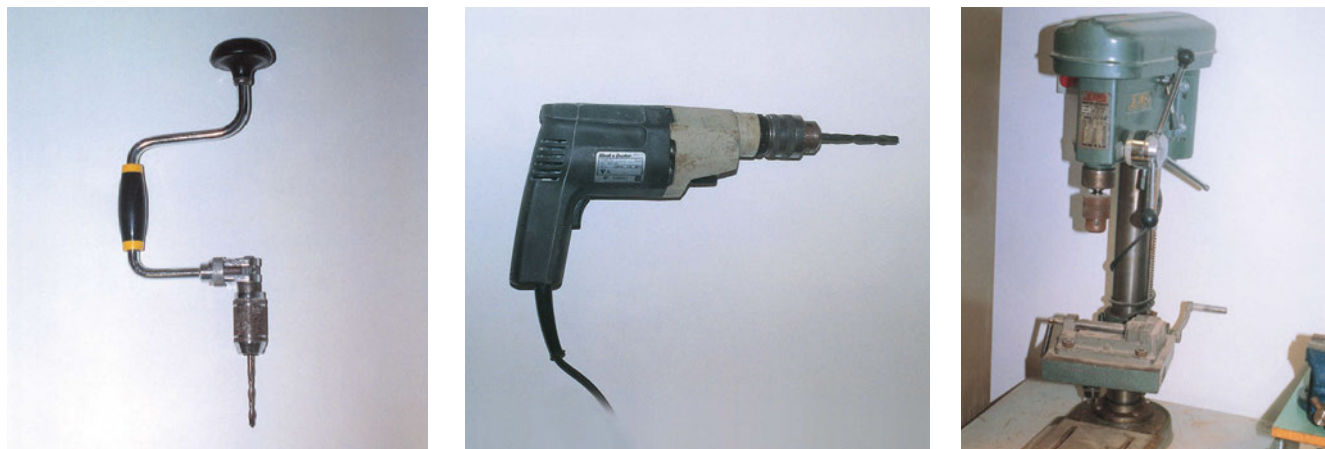
Εικόνα 4.21: Χειροδράπανο, ηλεκτρικό δράπανο χειρός, επιτραπέζιο ηλεκτρικό δράπανο.
