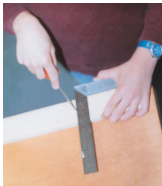
Εικόνα 4.12: Χάραξη ευθειών με τη βοήθεια σημαδούρας και γωνιάς.
