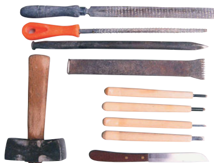
218. Εργαλεία λάξευσης: λί- μες, βελόνι, χτένι, μαχαίρια, κοπίδι, γούτζες, σκαρπέλο, βαριά.
