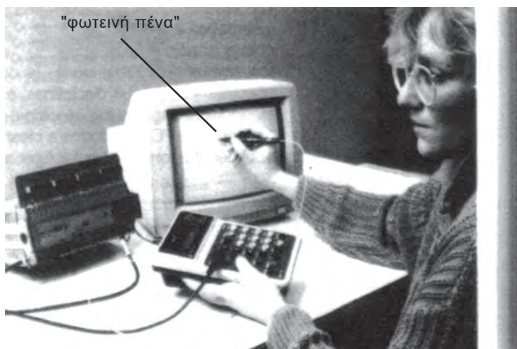
Σχήμα 11: Προγραμματισμός PLC με "φωτεινή πένα" (Light Pen).
