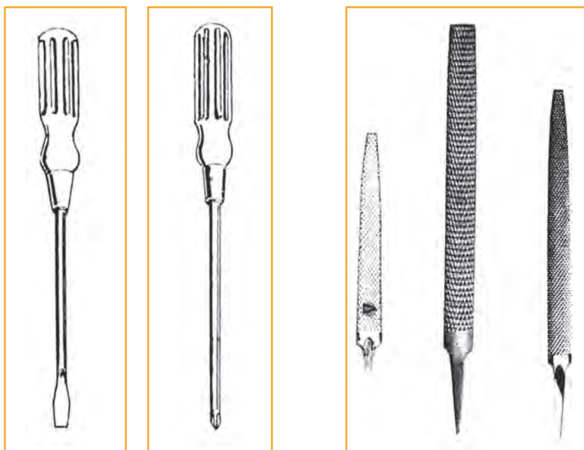
Εικόνα 2.10 Κοινό κατσαβίδι και σταυροκατσαβίδο
