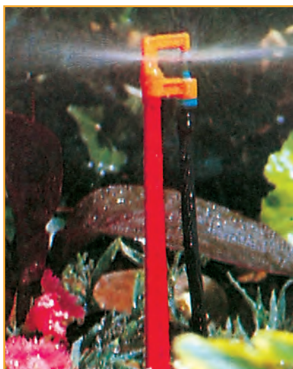
Εικόνα 7.10 (α, β) Μικροεκτοξευτήρες
