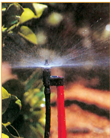
Εικόνα 7.10 (α, β) Μικροεκτοξευτήρες
