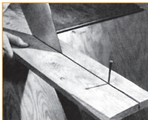
Εικόνα 2.2 Τοποθέτηση πρόκας στο άνοιγμα κοπής για τη διευκόλυνση του πριονίσματος
