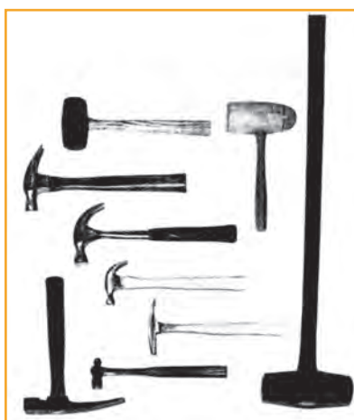
Εικόνα 2.8 Διάφορα είδη σφυριών
