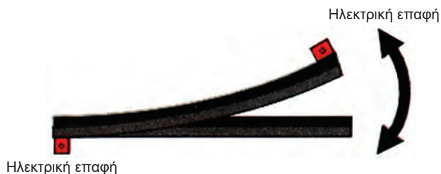
Σχήμα 2.58: Σχηματική παράσταση αρχής λειτουργίας διμεταλλικού ελάσματος.
