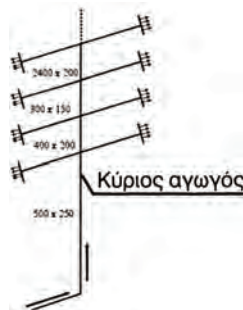
Σχήμα 2.53: Σχηματική παράσταση δικτύου με κεντρικό αγωγό μειούμενης διατομής.
