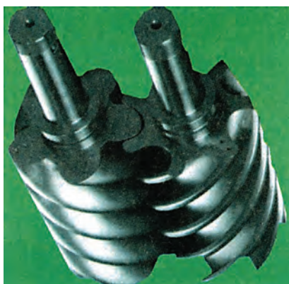
Εικόνα 2.1: Ζεύγος κοχλιόμορφων στροφείων σε συνεργασία.
