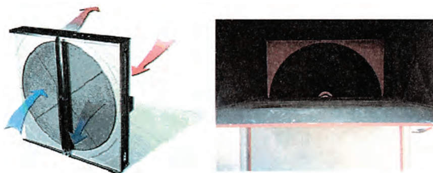
Σχήμα 3.10: Τροχός ανάκτησης θερμότητας/υγρασίας. Σχηματική διάταξή του (αριστερά) και εγκατάστασή του σε ΚΚΜ (δεξιά).
