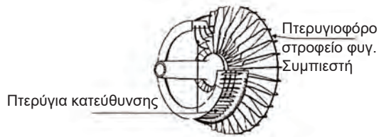
Σχήμα 2.10: Σχηματική παράσταση πτερυγιοφόρου στροφείου φυγοκεντρικού, συμπιεστή αξονικής εισόδου, με πτερύγια κατεύθυνσης.
