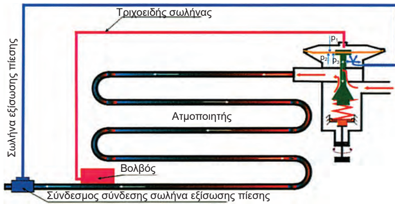
Σχήμα 2.28: Σχηματική παράσταση εγκατάστασης μιας θερμοστατικής εκτονωτικής βαλβίδας με εξωτερική εξίσωση της πίεσης. Η θέση στην οποία θα γίνει η λήψη της πίεσης εξίσωσης πρέπει να είναι μετά από το βολβό (ακολουθώντας τη ροή του ψυκτικού μέσα στο ψυκτικό κύκλωμα).
