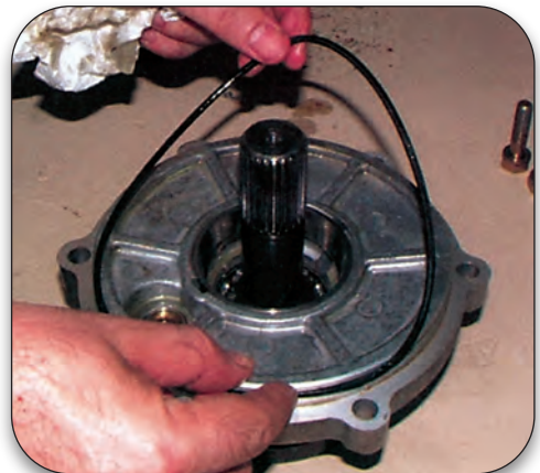
Σχήμα 1.44: Αντικατάσταση του O-ring στεγανοποίησης.
