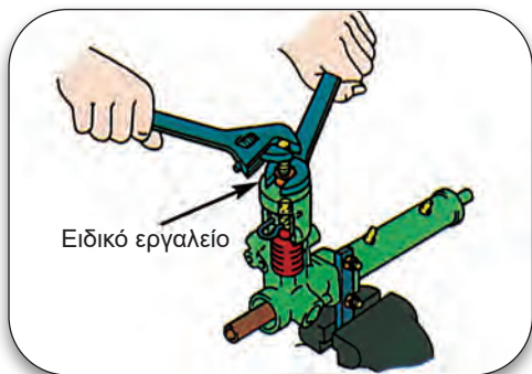
Σχήμα 2.46: Εξαγωγή βαλβίδας ελέγχου.
