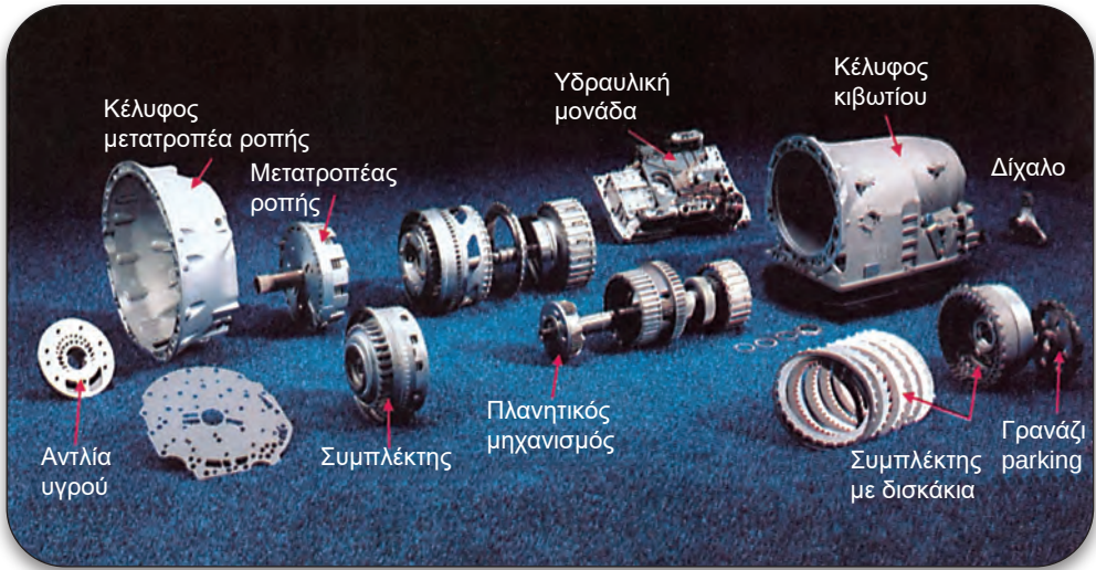
Σχήμα 1.1: Κυριότερα εξαρτήματα ενός αυτόματου κιβωτίου ταχυτήτων.
