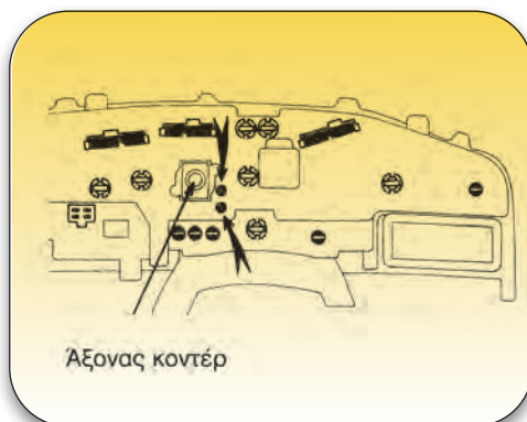
Σχήμα 3.22: Έλεγχος αισθητήρα ταχύτητας.
