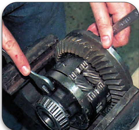
Σχήμα 1.38: Αφαίρεση κεντρικού πλανητικού συστήματος από την κορόνα.
