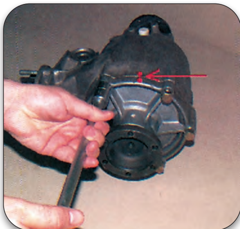
Σχήμα 1.34: Βάζετε σημάδια (κόκκινο χρώμα) και αφαιρείτε με τη σειρά τις περιφερειακές βίδες.
