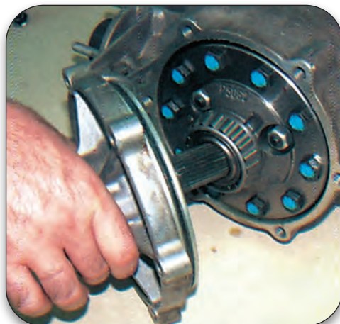
Σχήμα 1.36: Αφαίρεση καπακιού διαφορικού.
