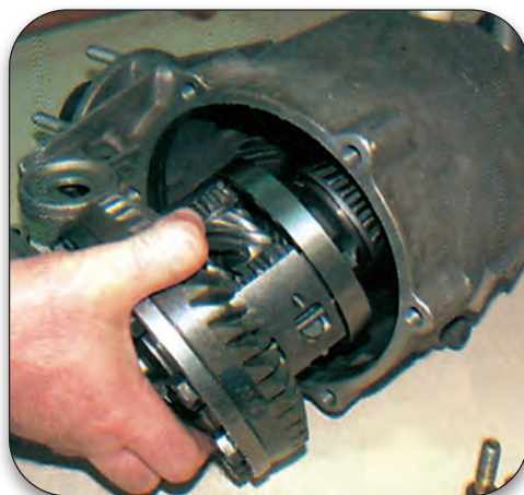
Σχήμα 1.37: Αφαίρεση κεντρικού πλανητικού συστήματος.
