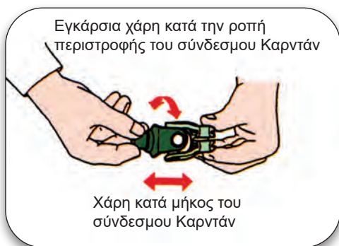
Σχήμα 2.34: Έλεγχος τζόγου συνδέσμων καρντάν.
