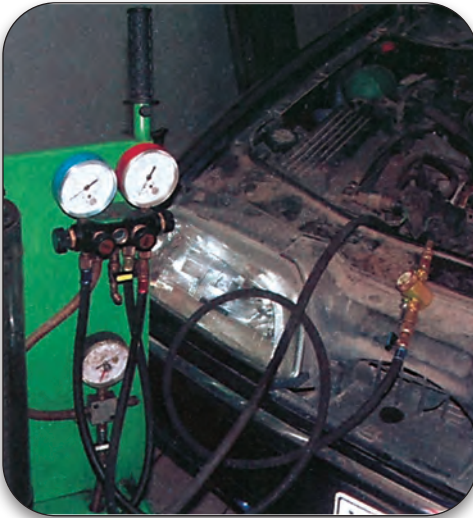
Σχήμα 6.7: Διάταξη οργάνων και αγωγών συσκευής πλήρωσης και αντλία κενού σε αυτοκίνητο.
