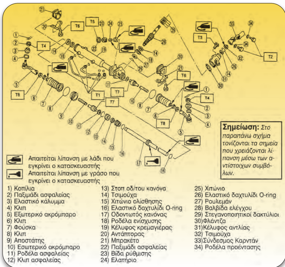
Σχήμα 2.62: Σχηματική διάταξη των εξαρτημάτων που απαρτίζουν το σύστημα διεύθυνσης.
