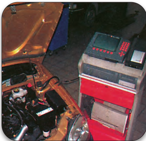
Σχήμα 6.10: Συσκευή διάγνωσης λειτουργίας κλιματιστικού.
