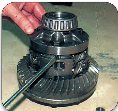
Σχήμα 1.39: Αφαίρεση καπακιού πλανητικού συστήματος.
