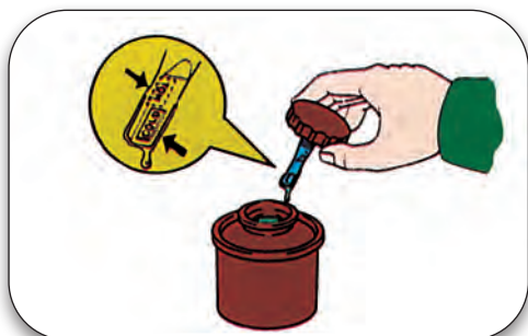
Σχήμα 2.16: Έλεγχος στάθμης υδραυλικού λαδιού.
