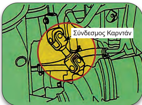
Σχήμα 2.27: Αφαίρεση συνδέσμων καρντάν.
