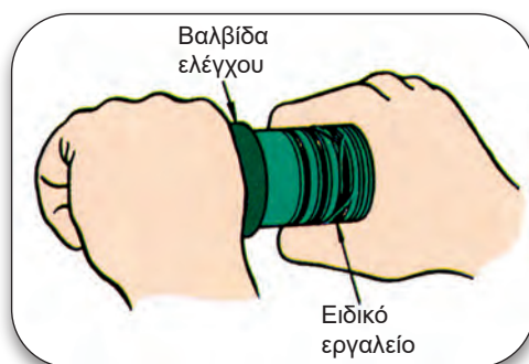
Σχήμα 2.59: Συναρμολόγηση βαλβίδας ελέγχου.
