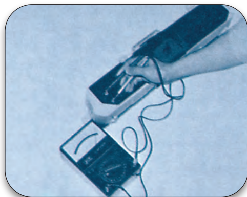
Σχήμα 5.2: Έλεγχος ωμικής αντίστασης.
