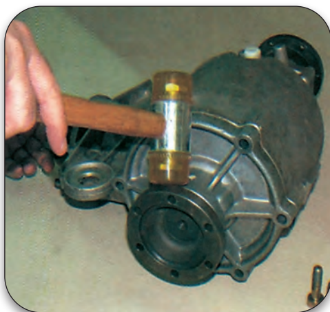
Σχήμα 1.35: Αφαιρείτε με προσοχή το καπάκι του διαφορικού.
