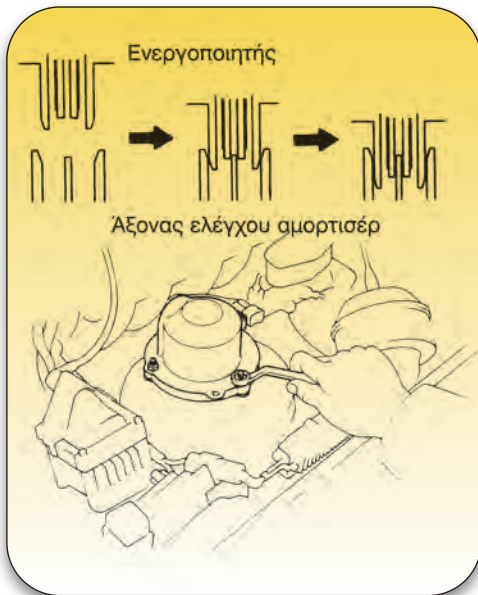
Σχήμα 3.18: Διαδικασία σύνδεσης ενεργοποιητή.
