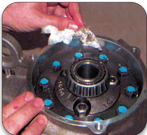
Σχήμα 1.45: Σχολαστικός καθαρισμός με καθαρό πανί των επιφανειών, ώστε το σημείο σύνδεσης να είναι στεγανό.
