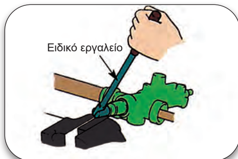
Σχήμα 2.43: Αφαίρεση βιδωτής τάπας.
