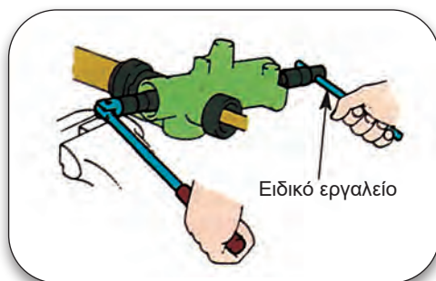
Σχήμα 2.44: Αφαίρεση αυτασφαλισμένου παξιμαδιού και ρουλεμάν.
