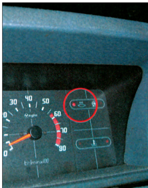
Σχήμα 13: Το άναμμα της προειδοποιητικής λυχνίας με την ένδειξη CHECK ENGINE δείχνει ότι μια βλάβη έχει καταγραφεί στη μνήμη KAM.
