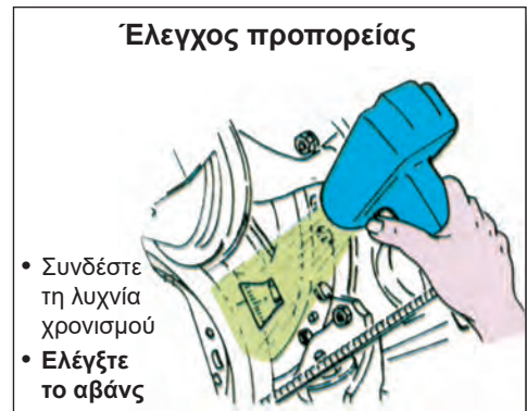
Σχήμα 13: Έλεγχος προπορείας με στροβοσκοπική λυχνία.
