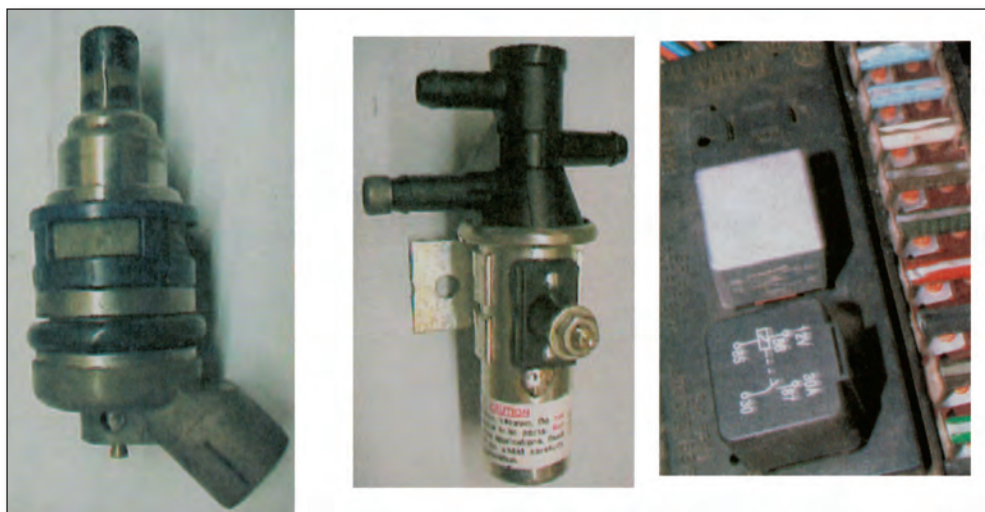
Σχήμα 3: Ηλεκτρομαγνητικές βαλβίδες και κιβώτιο ηλεκτρονόμων.
