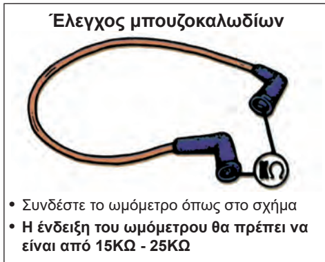
Σχήμα 10: Έλεγχος μπουζοκαλωδίων με ωμόμετρο.
