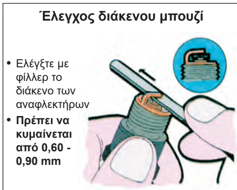
Σχήμα 11: Έλεγχος αναφλεκτήρων (μπουζί) με φίλλερ.
