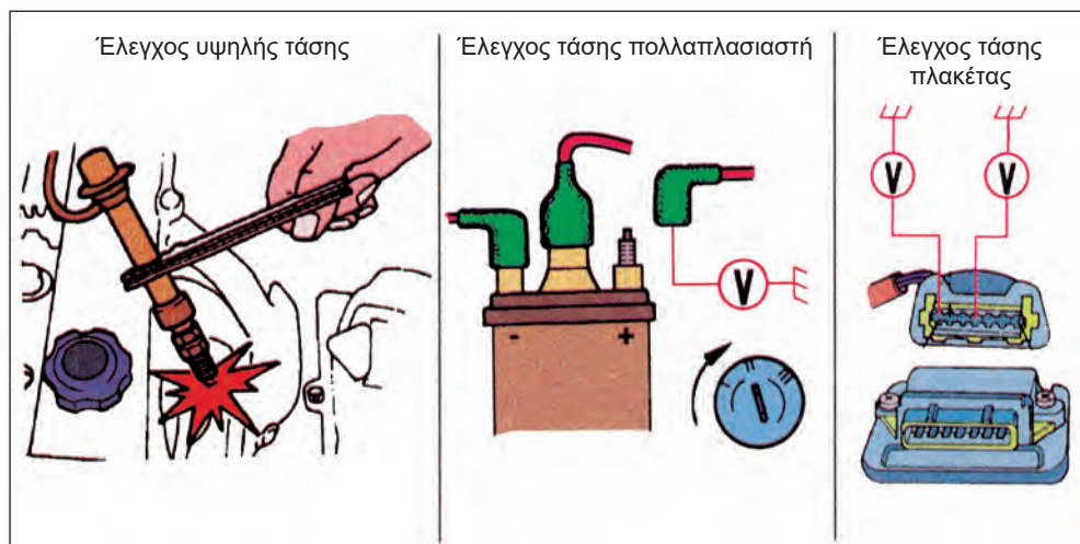
Σχήμα 18: Έλεγχοι εξαρτημάτων ηλεκτρονικής ανάφλεξης.
