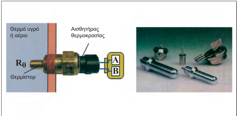
Σχήμα 15: Αισθητήρες θερμοκρασίας με ακροδέκτες δυο επαφών A και B.
