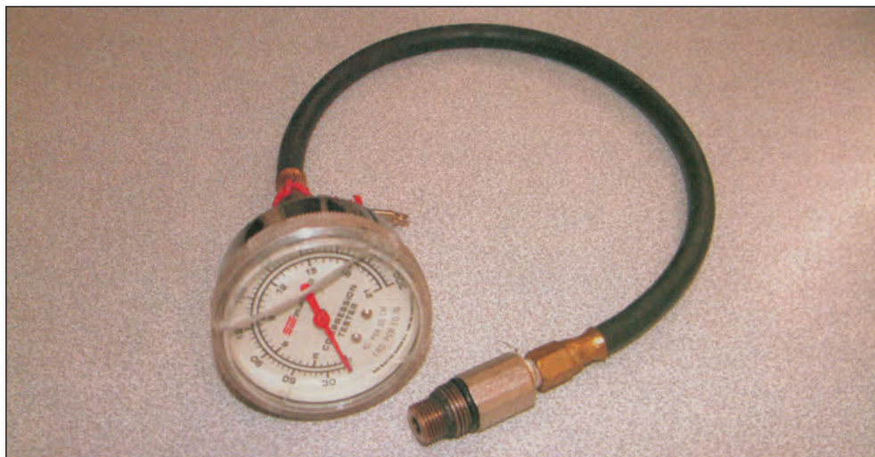
Σχήμα 10: Πιεσόμετρο με προσαρμογέα (αντάπτορα).
