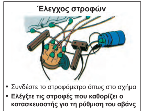
Σχήμα 12: Έλεγχος στροφών ρελαντί.
