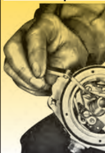
Σχήμα 8: Έλεγχος με φίλερ του διάκενου πλατινών.
