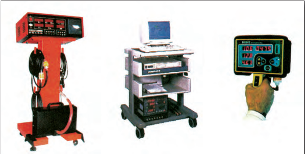
Σχήμα 13: Διάφορα είδη οργάνων και συσκευών αναλυτών καυσαερίων.
