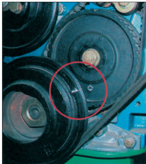
Σχήμα 3: Σημάδια ελέγχου της ρύθμισης του χρονισμού.
