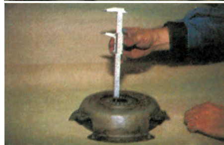
Σχήμα 4: Έλεγχος φθοράς και ύψους του ελατηριωτού διαφράγματος.
