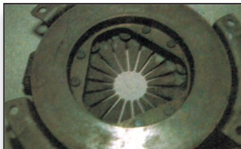
Σχήμα 5: Έλεγχος της πλάκας πίεσης.
