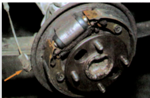
Σχήμα 5: Αποσύνδεση του μηχανισμού του χειρόφρενου.
