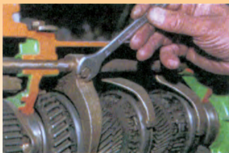
Σχήμα 9: Αφαίρεση των ασφαλειών των οδηγών και των διχάλων.
