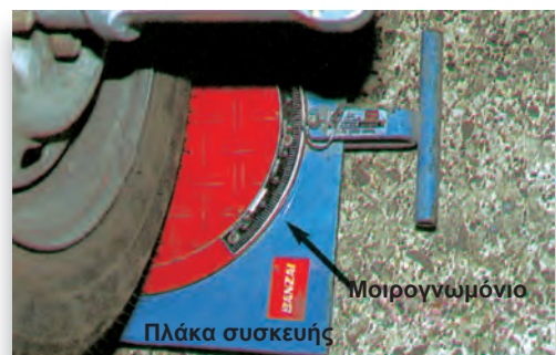
Σχήμα 2: Πλάκα και μοιρογνωμόνιο ευθυγράμμισης.
