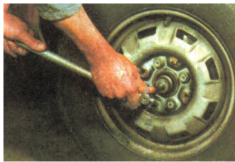
Σχήμα 9: Αφαίρεση του καλύμματος και του κεντρικού περικοχλίου του ημιαξονίου.
