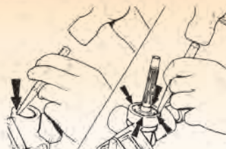
Ξεβίδωμα του ασφαλιστικού παξιμαδιού του άξονα διεύθυνσης
