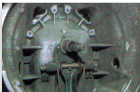
Σχήμα 10: Έλεγχος του πολύσφηνου του πρωτεύοντα άξονα του κιβωτίου ταχυτήτων.
