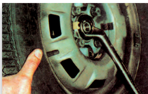
Σχήμα 3: Λασκάρισμα του κεντρικού παξιμαδιού.
