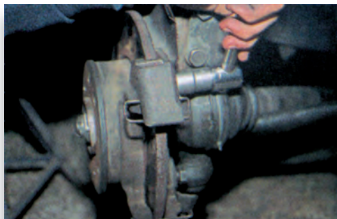
Σχήμα 12: Αφαίρεση του στηρίγματος του δισκόφρενου.
