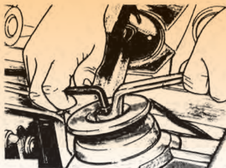
Σχήμα 2: «Λασκάρισμα» του περικοχλίου ασφαλείας του βάρτρου του εμβόλου.
