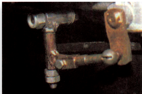
Σχήμα 3: Αποσύνδεση του μηχανισμού αλλαγής ταχυτήτων.
