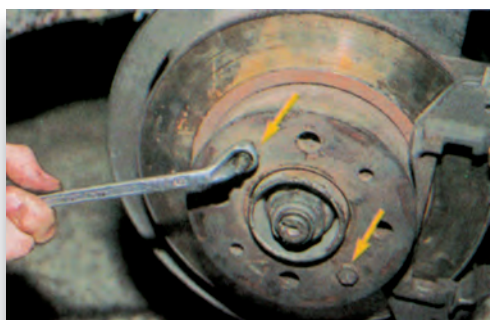
Σχήμα 13: Αφαίρεση δίσκου (δισκόπλακας).
