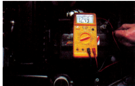
Σχήμα 5: Έλεγχος του συσσωρευτή με δοκιμαστικό και με βολτόμετρο.
