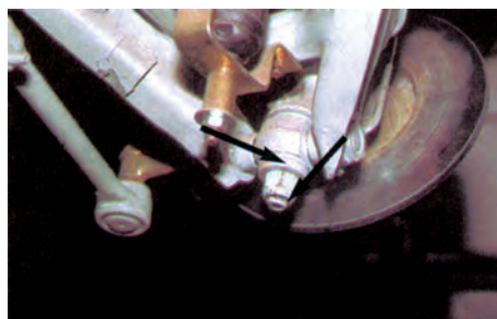
Σχήμα 3: Αφαίρεση σφαιρικού συνδέσμου από το ψαλίδι.
