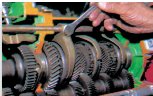
Σχήμα 16: Αφαίρεση των κοχλιών συγκράτησης των διχάλων.
