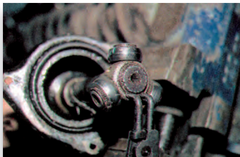
Σχήμα 8: Αφαίρεση του τρίποδα της φουσούνας και της τσιμούχας.
