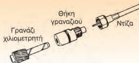
Σχήμα 11: Αφαίρεση του γραναζιού του χιλιομετρητή.
