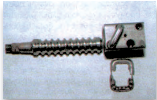
Σχήμα 7. Αφαίρεση περικοχλίων και σφαιριδίων.
