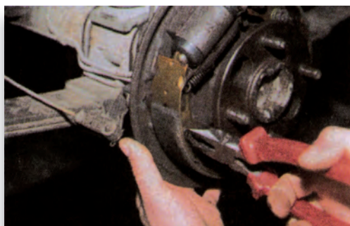
Σχήμα 4: Αφαίρεση ελατηρίου του πείρου στερέωσης.
