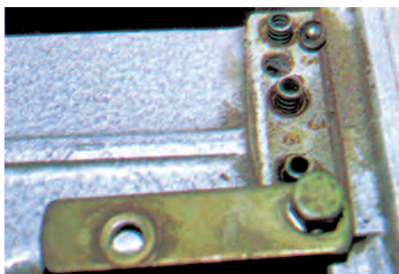
Σχήμα 15: Αφαίρεση της πλάκας συγκράτησης και των ασφαλειών.
