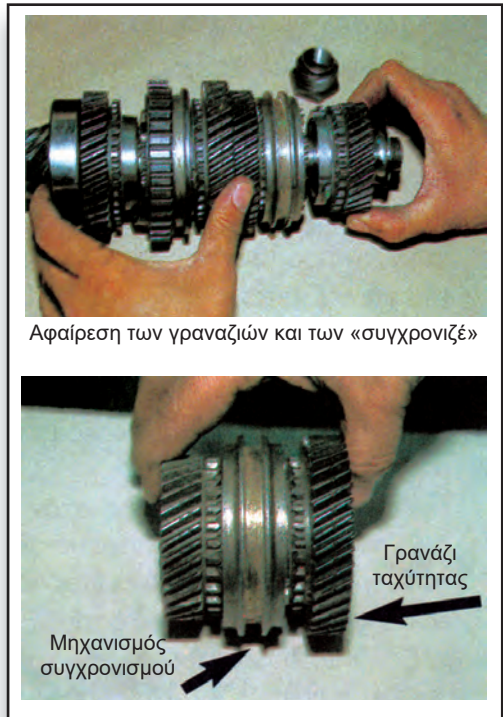
Σχήμα 2: Αποσυναρμολόγηση δευτερεύοντα.
