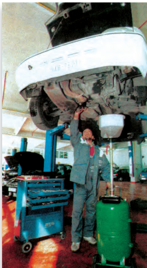
Σχήμα 1: Αντικατάσταση λιπαντικού κιβωτίου ταχυτήτων.
