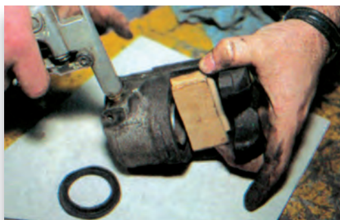
Σχήμα 11: Αφαίρεση εμβόλου δαγκάνας.
