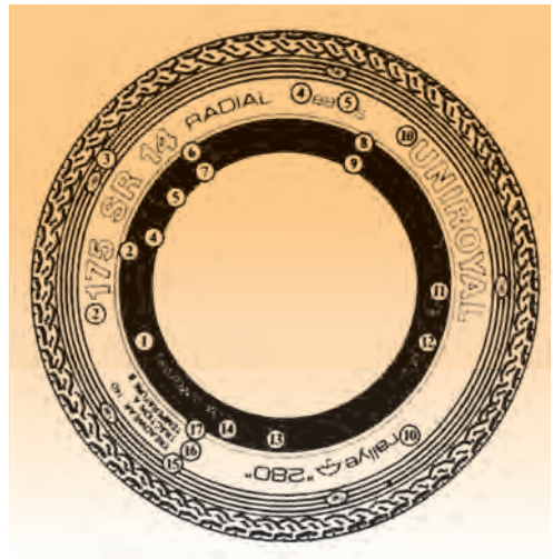
Σχήμα 1: Χαρακτηριστικά των ελαστικών που αναγράφονται επί του ελαστικού.
