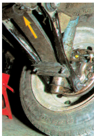
Σχήμα 6: Αφαίρεση των στηριγμάτων του ελατηρίου από το πλαίσιο ή το αμάξωμα.
