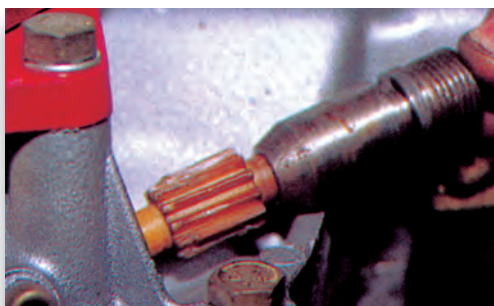
Σχήμα 19: Αφαίρεση του γραναζιού του χιλιομετρητή.
