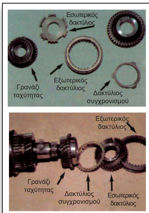
Σχήμα 3: Αποσυναρμολογημένος μηχανισμός συγχρονισμού.
