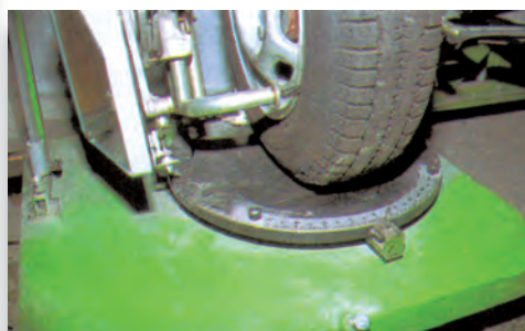
Σχήμα 7: Τοποθέτηση οχήματος στη συσκευή ευθυγράμμισης.
