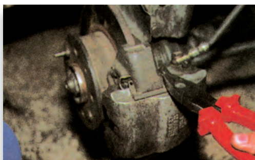
Σχήμα 3: Αφαίρεση των ασφαλειών των βάσεων της δαγκάνας.
