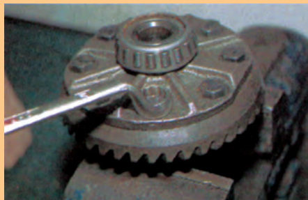
Σχήμα 4: Λύσιμο και αφαίρεση καβαλέτων και ρουλεμάν.
