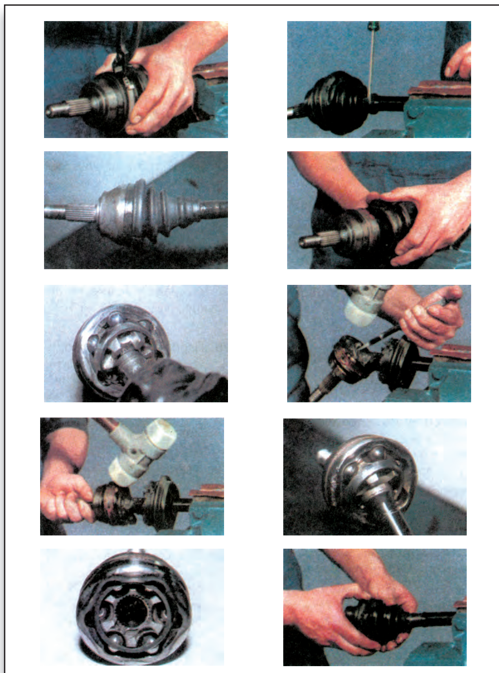
Σχήμα 7: Διαδικασία αποσυναρμολόγησης του συνδέσμου.
