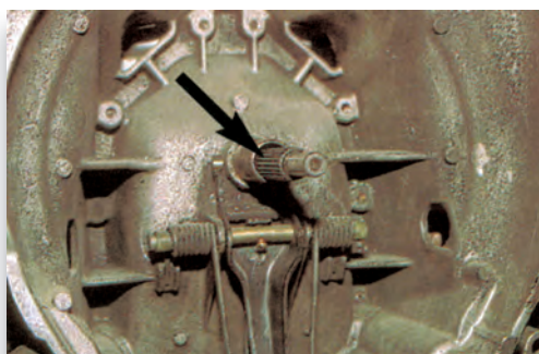
Σχήμα 12: Έλεγχος του κελύφους του συμπλέκτη για διαρροές.
