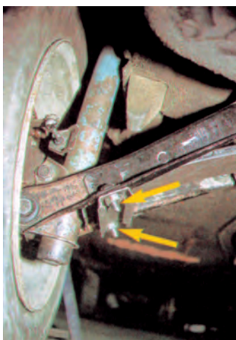
Σχήμα 5: Αποφόρτιση ελατηρίου και αφαίρεση του ελατηρίου από το ψαλίδι.
