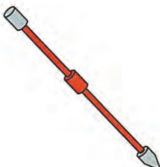
Επιχαλκωμένο με χαλύ- βδινη ψυχή ηλεκτρόδιο μορφής ράβδου κυκλικής διατομής.
