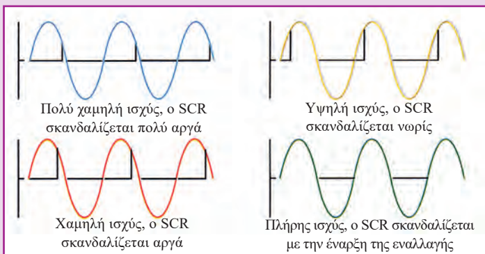
Σχήμα 4.9 Έλεγχος κατανάλωσης φορτίου σε ένα κύκλωμα AC με SCR.
