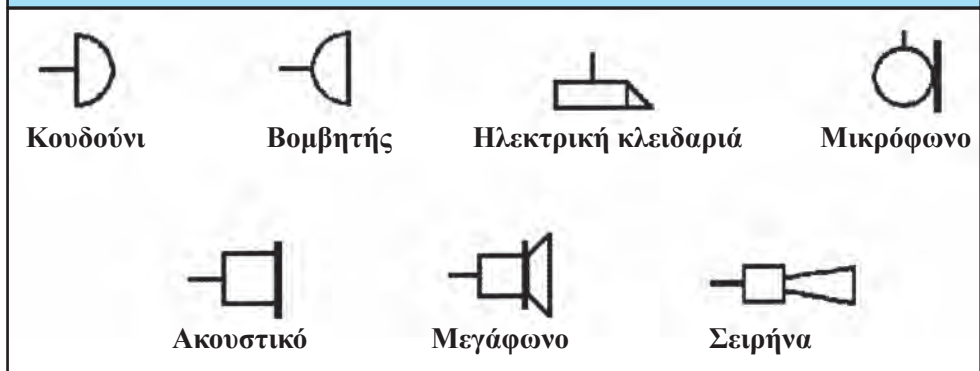
Σχήμα 10.1α: Σύμβολα κατά DIN
