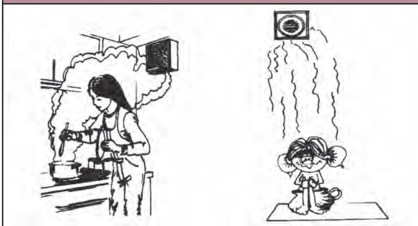
Σχήμα 9.3β: Θέση εξαεριστήριων
