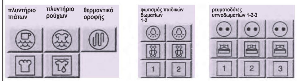
Εικόνα 7.4α: Παραδείγματα συστήματος σήμανσης των κυκλωμάτων
