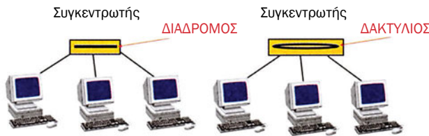
Σχήμα 5.2.10 Τοπολογίες τοπικών δικτύων και καλωδιώσεις
