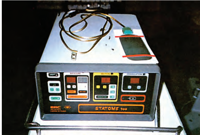
Εικ. 11. Σύγχρονη ηλεκτρονική συσκευή χειρουργικής διαθερμίας. Διακρίνεται η πλάκα γείωσης μιας χρήσεως (αρνητικό καλώδιο).
