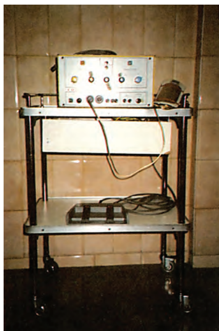
Εικ. 10. Παλαιότερη συσκευή χειρουργικής διαθερμίας όπου διακρίνεται ο ποδοδιακόπτης και η πλάκα γείωσης.
