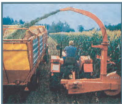
Εικόνα 9.3 Κοπή και τεμαχισμός χλόης καλα- μποκιού για ενσίρωση
