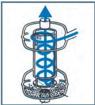
Εικ.4.11 Μηχανισμός λειτουργίας του φίλτρου, με την είσοδο του νερού και το πέρασμά του από το κατώτερο μέρος που υπάρχει η άμμος.
