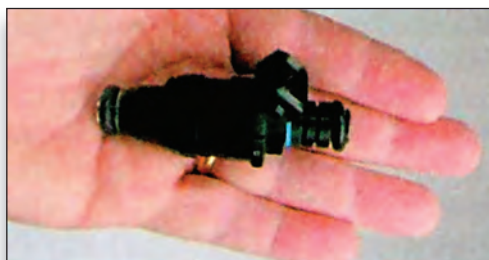
Σχήμα 5.17: Ηλεκτρομαγνητική βαλβίδα ψεκασμού καυσίμου.
