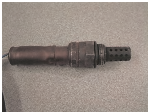
Σχήμα 6.50: Αισθητήρας λάμδα (λ) και καμπύλη τάσης εξόδου του.
