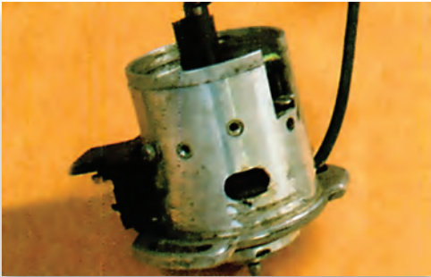
Σχήμα 6.14: Φωτοηλεκτρικός αισθητήρας ταχύτητας στροφών άξονα. Το πιο δύσκολο τεχνικό πρόβλημα είναι η ευθυγράμμιση των στοιχείων του για την οπτική ζεύξη. Η λύση είναι η χρησιμοποίηση συμπαγούς μονάδας οπτικού ζεύκτη, που είναι σωστά ευθυγραμμισμένη από τον κατασκευαστή.
