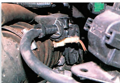
Σχήμα 6.35: Αισθητήρας θερμοκρασίας εισερχομένου αέρα στην πολλαπλή εισαγωγή. Συνήθως βρίσκεται αμέσως μετά από το φίλτρο αέρα στον αεραγωγό, που οδηγεί από το φίλτρο αέρα στην πολλαπλή εισαγωγή.
