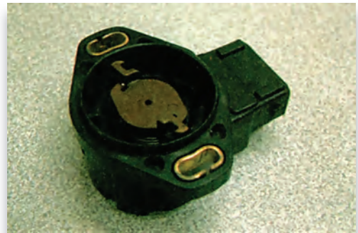
Σχήμα 6.11: Αισθητήρας Hall ταχύτητας στροφών άξονα. Διαθέτει τρεις ακροδέκτες. Οι δυο χρησιμοποιούνται για τροφοδοσία και ο τρίτος για τη μετάδοση του σήματος στο μικροϋπολογιστή μέσω του βύσματος. Έχει αξιόπιστη λειτουργία σε θερμοκρασίες από -40 μέχρι +150\text{ }^{\circ}\text{C} .
