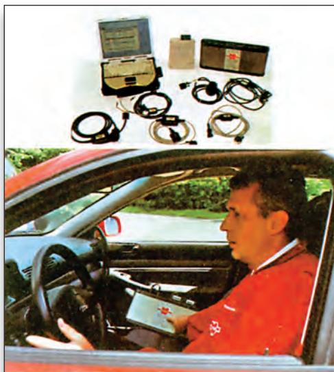
Σχήμα 8.3: Σύστημα αυτοδιάγνωσης γενικής χρήσης (universal). Σε ένα τέτοιο σύστημα μπορεί να βρει κανείς διάφορα είδη σχεδίων του αυτοκινήτου (ηλεκτρικά, ηλεκτρονικά), γνωστά υπάρχοντα προβλήματα και άλλες χρήσιμες πληροφορίες, τις οποίες μάλιστα μπορεί και να εκτυπώσει.
