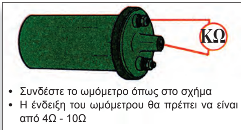
Σχήμα 9.31: Έλεγχος δευτερεύοντος πηνίου πολλαπλασιαστή.
