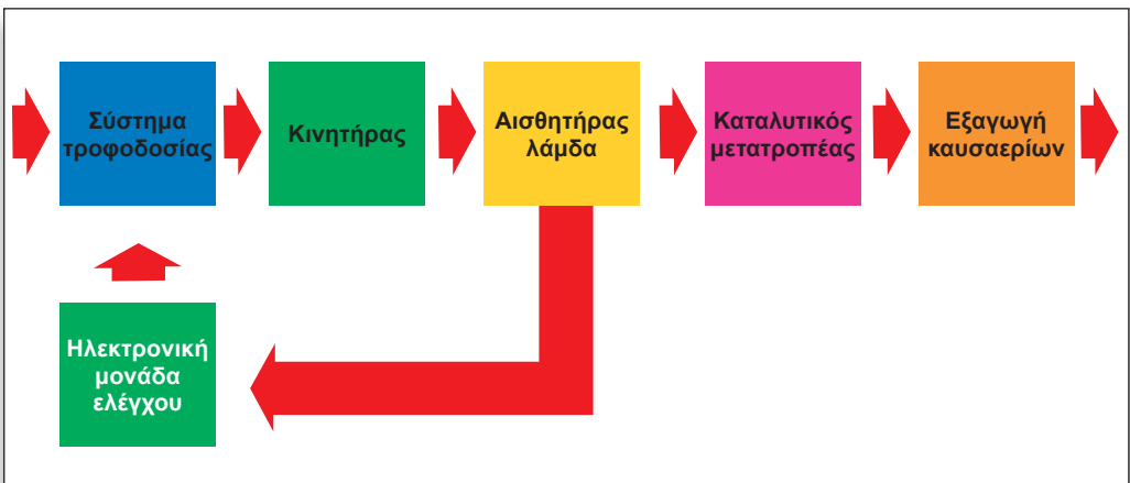
Σχήμα 4.2: Σχηματικό διάγραμμα κλειστού βρόχου σύγχρονης τεχνολογίας.
