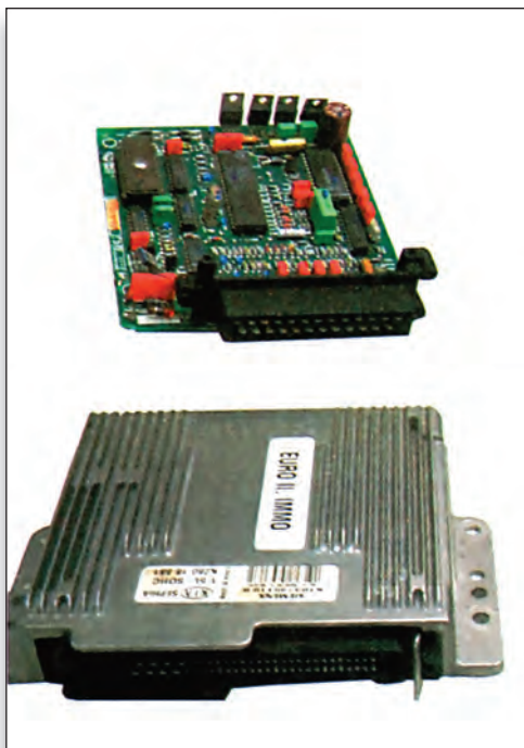
Σχήμα 5.10: Εξωτερική - εσωτερική εμφάνιση κεντρικής μονάδας ελέγχου αυτοκινήτου.
