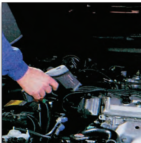
Σχήμα 2.19: Μέτρηση της θερμοκρασίας με θερμόμετρο υπέρυθρων ακτίνων.
