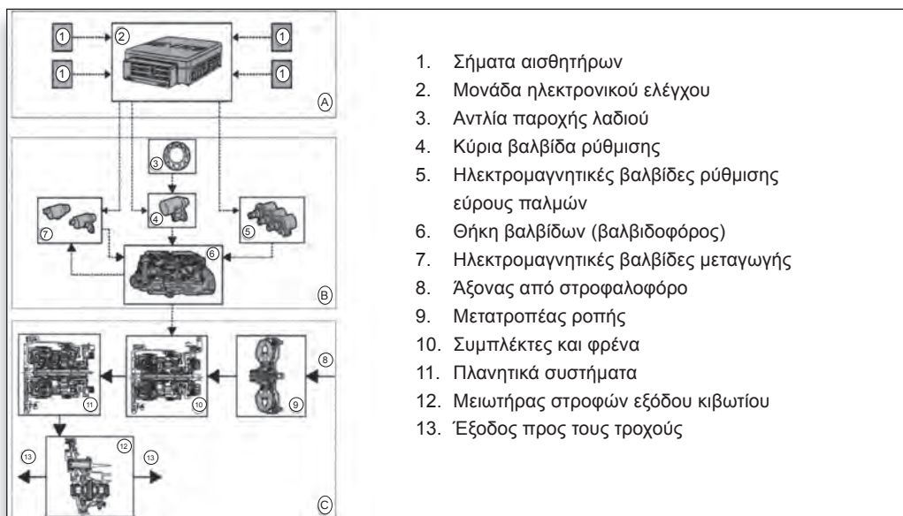
Σχήμα 10.3: Διάγραμμα ηλεκτρονικού ελέγχου κιβωτίου ταχυτήτων.
