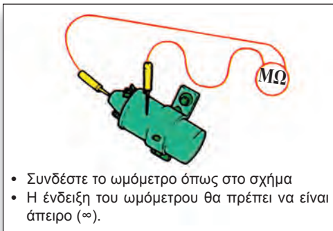
Σχήμα 9.32: Έλεγχος βραχυκυκλώματος πολλαπλασιαστή.
