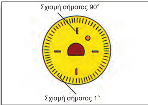
Σχήμα 6.24: Δίσκος με σχισμές 90^\circ και 1^\circ .
