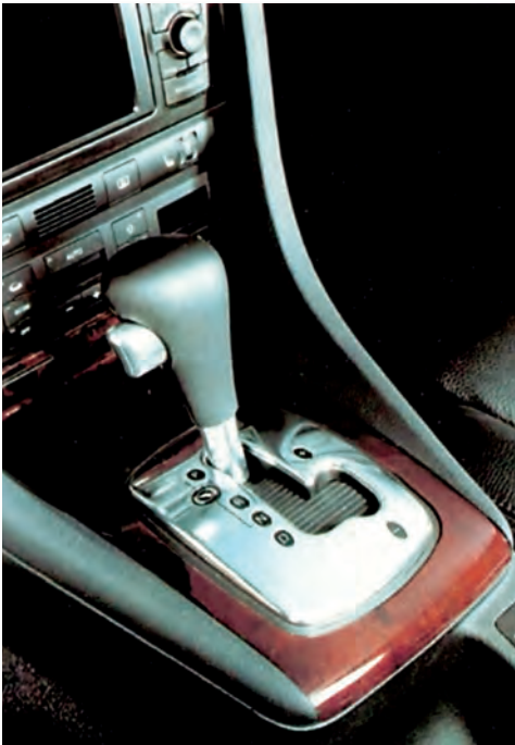
Σχήμα 1.51: Επιλογέας με θέσεις για σειριακή λειτουργία.
