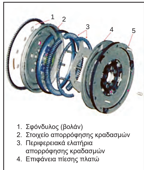
Σχήμα 1.5: Συμπλέκτης με βολάν διπλής μάζας.
