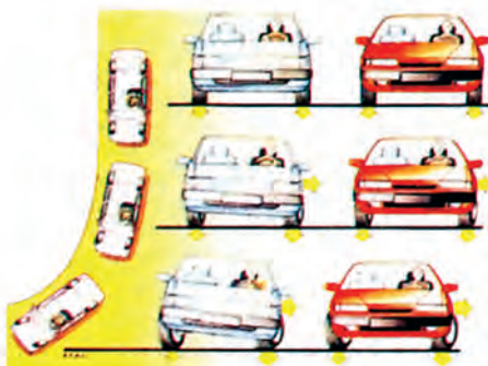
Σχήμα 3.13: Οι τρεις φάσεις λειτουργίας της υδροενεργητικής ανάρτησης.
