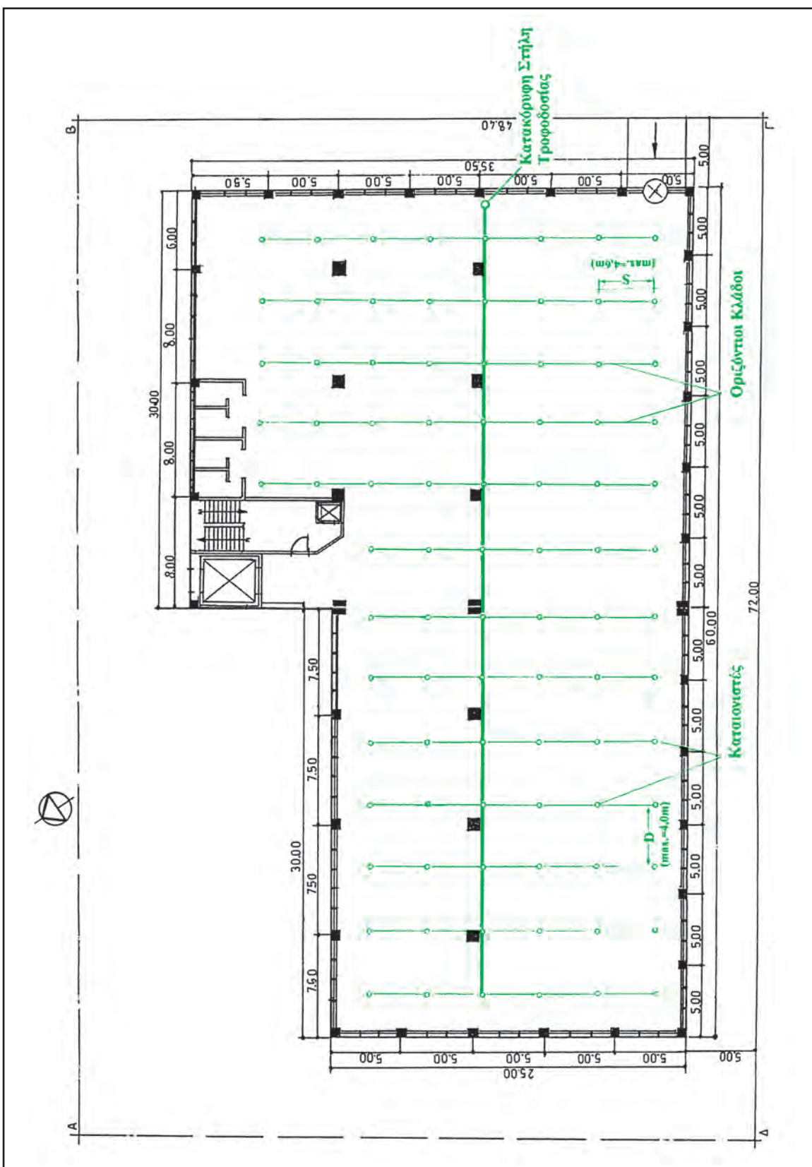
(σχ. 8.2.6.ε) Κάτοψη Ισογείου - Σύστημα Καταιονισμού (SPRINKLERS)
