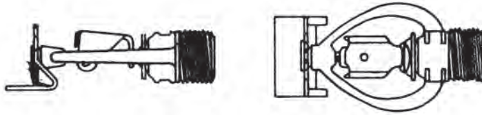
(σχ. 8.2.6.β) Καταιονιστές Πλευρικού Τύπου
