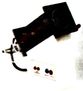
Σχ. 3.1 Η συσκευή που θα χρησιμοποιήσουμε αποτελείται από ένα καθοδικό σωλήνα που περιβάλλεται από πηνίο.
