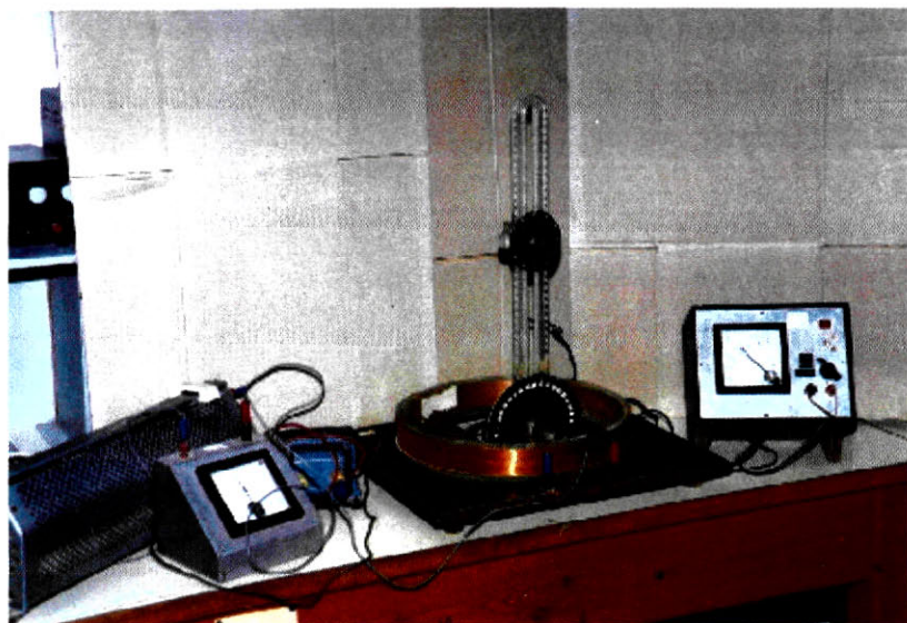
Εικόνα 4-1: Φωτογραφία του κυκλικού αγωγού. Διακρίνεται όρθιο στη μέση του το διερευνητικό πηνίο.
