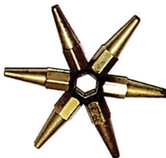
Σχήμα 8.3.7δ: Σετ ακροφυσίων καυστήρα βιδωμένα στην ειδική βάση τους
