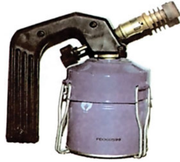
Σχήμα 8.2.2β Καμινέτο με καυστήρα προπανίου για το πύρωμα της κεφαλής του κολλητηριού
