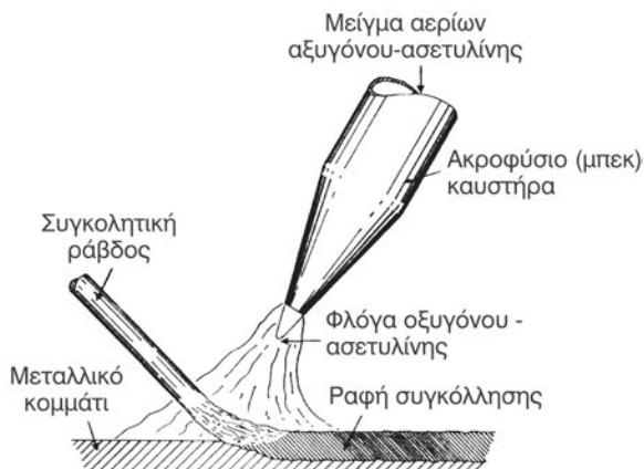
Σχήμα 8.3.1α: Η αρχή λειτουργίας της οξυγονοσυγκόλλησης
