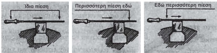
Σχήμα 4.12δ Πόσο πιέζουμε τη λίμα
