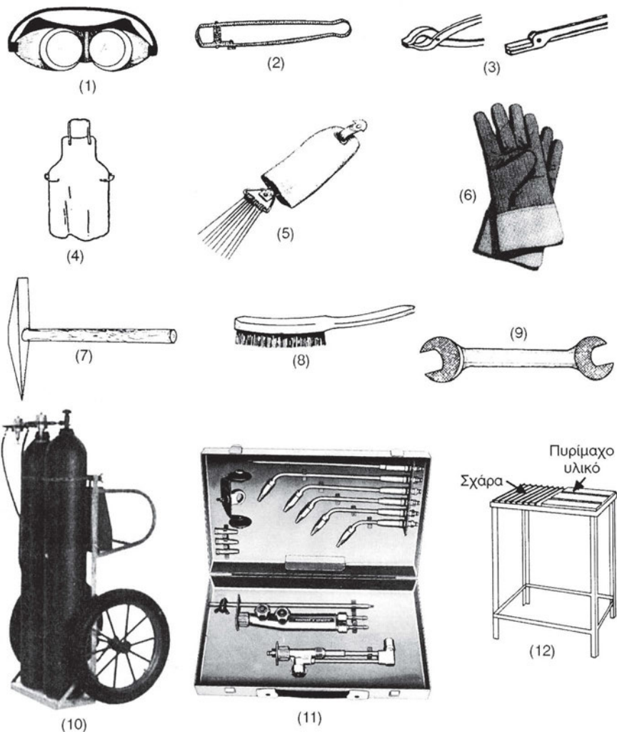
Σχήμα 8.3.8α: Εργαλεία και βοηθητικά εξαρτήματα οξυγονοσυγκολλητή.
