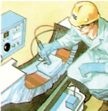
Σχήμα 12.3α Επιμετάλλωση με ηλεκτρόλυση: -1. Φορητή Μονάδα για επιτόπια επισκευή, -2. Συμπαγής Μονάδα για μικροαντικείμενα
