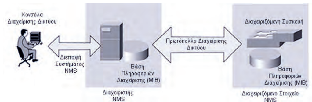
Εικόνα 7.1.α: Βασική δομή Συστήματος Διαχείρισης Δικτύου (NMS)
