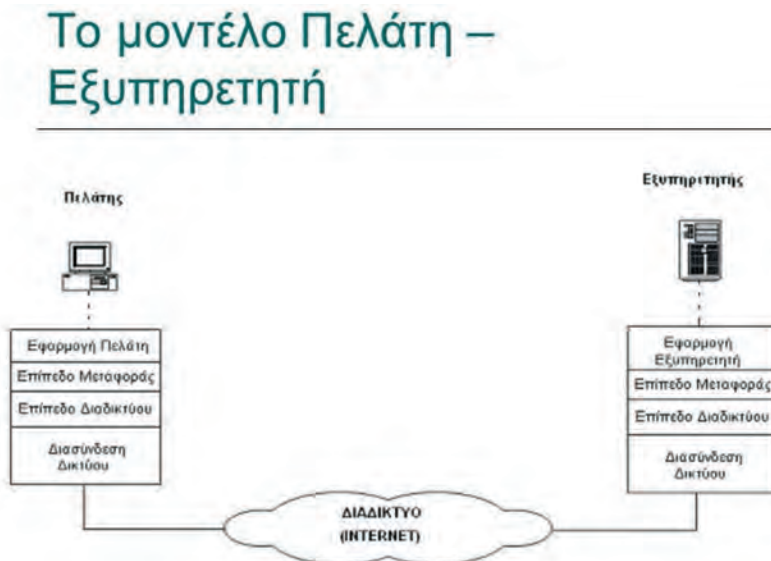
Σχήμα 6.2.α.: Το μοντέλο Πελάτη-Εξυπηρετητή σύμφωνα με το μοντέλο TCP/IP (Πηγή: http://images.slideplayer.gr/7/1959162/slides/slide_34.jpg )
