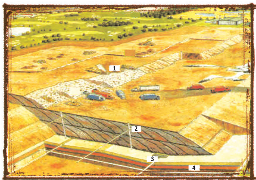
Εικόνα 104 Λειτουργία ενός ΧΥΤΑ. 1.-Μέτωπο εργασίας 2.-Στρώσεις απορριμμάτων 3.-Αγωγοί βιοαερίου 4.-Στεγανωτικές στρώσεις.[10]
