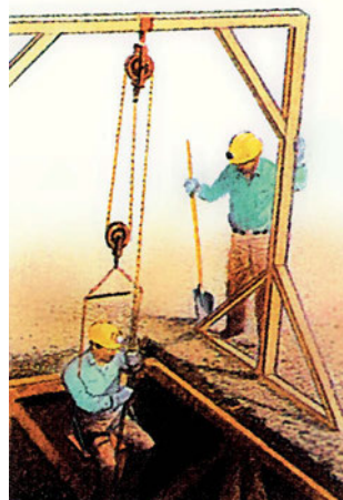
Εικόνα 5.9: Συνδυασμός ακίνητης και κινητής τροχαλίας(πολύσπαστο)
