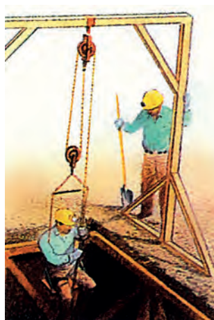
Εικόνα 5.9: Συνδυασμός ακίνητης και κινητής τροχαλίας(πολύσπαστο)
