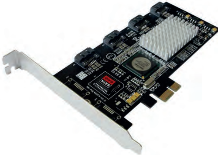
Εικόνα 3.8. Ελεγκτής για δημιουργία RAID.
