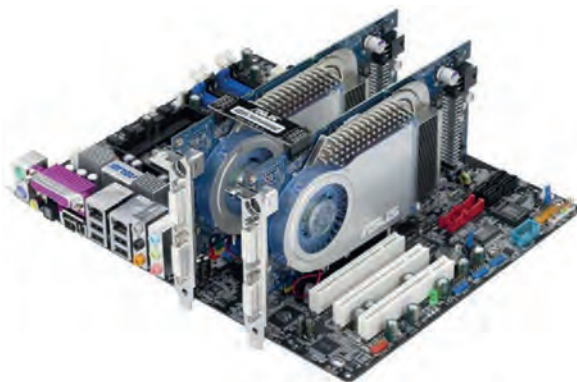
Εικόνα 1.3: Εγκατάσταση διπλών καρτών γραφικών τεχνολογίας SLI
