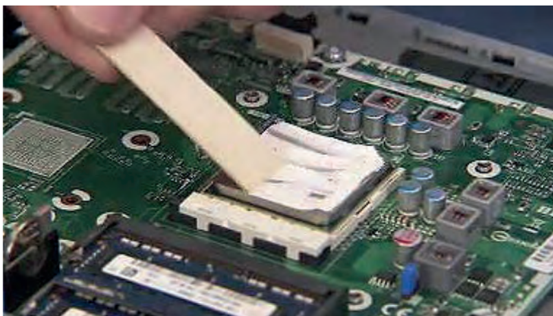
Εικόνα 2.7: Εφαρμογή θερμοαγώγιμης πάστας
