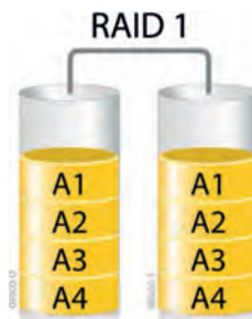
Εικόνα 3.2. Συστοιχία RAID 1 (mirroring).
