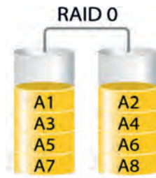
Εικόνα 3.1. Συστοιχία RAID 0 (striping).
