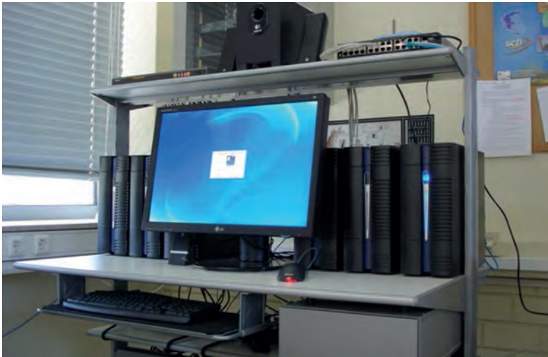
Εικόνα 4.2. Η συστοιχία υπολογιστών που έφτιαξαν οι μαθητές του 1ου ΕΠΑΛ Αργυρούπολης αποτελείται από 6 υπολογιστές με διπύρνηνο επεξεργαστή και 2 GB RAM.
