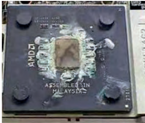
Εικόνα 2.1: Κατεστραμμένη Κ.Μ.Ε., λόγω υπερθέρμανσης
