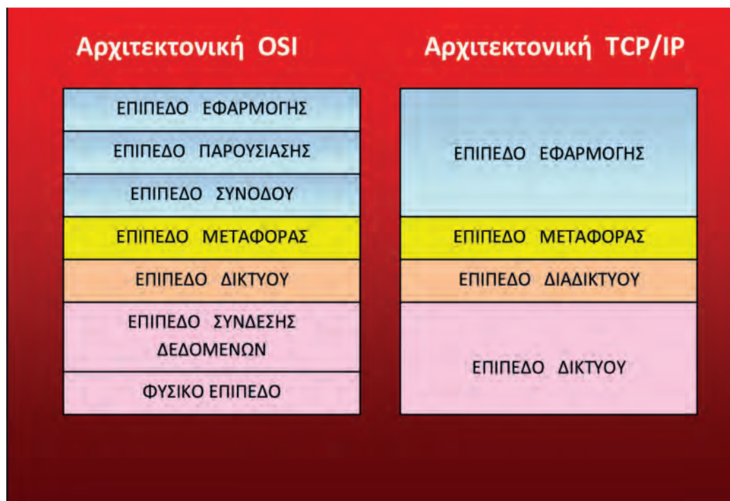
Σχήμα 1.15 Σύγκριση των Αρχιτεκτονικών TCP/IP και OSI
