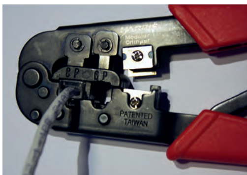
Εικόνα 10: Πρεσάρισμα φισ RJ45
