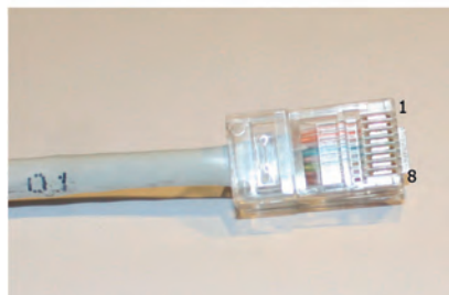
Εικόνα 9: Τοποθέτηση στο φισ RJ45
