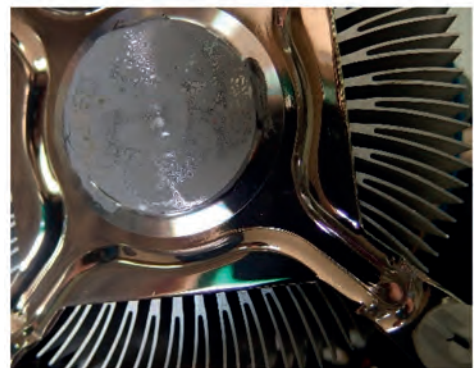
Εικόνα 65. Κατάλοιπα θερμοαγωγίμης κόλλας
