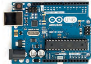
Εικόνα 18.Μικροελεγκτής Arduino – Πηγή: R.Hampl https://upload.wikimedia.org/wikipedia/commons/a/a8/ArduinoUno_R3_Front_450px.jpg
