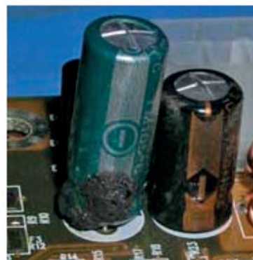
Εικόνα 263: Κατεστραμμένος πυκνωτής σε μητρική πλακέτα
