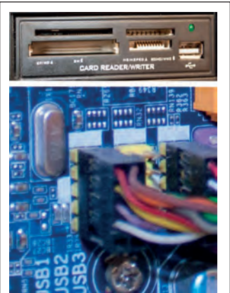
Εικόνα 152: Αναγνώστης καρτών και σύνδεση του στην μητρική πλακέτα
