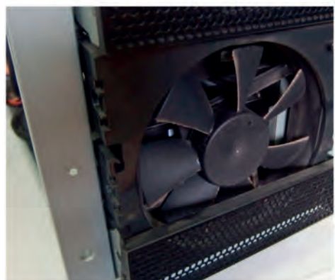
Εικόνα 52. Ανεμιστήρας πρόσοψης της θήκης της KM
