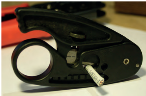
Εικόνα 5: Απογυμνωτής εξωτερικής μόνωσης καλωδίων UTP
