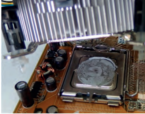
Εικόνα 63. Αφαίρεση συστήματος ψύξης
