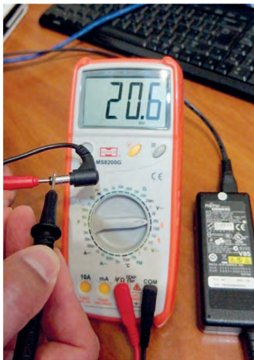
Εικόνα 196. Μέτρηση τροφοδοτικού με πολύμετρο
