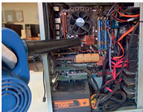
Εικόνα 68.Καθαρισμός με ηλεκτρικό φουσητήρα
