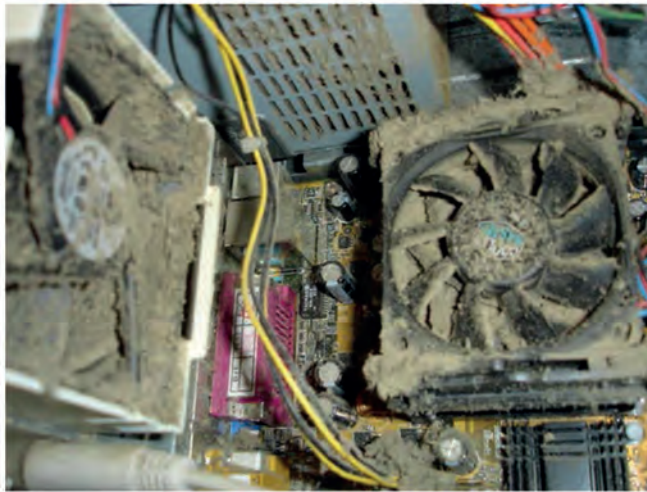
Σχ. 2.10 Η σκόνη αποτελεί σημαντική αιτία για την υπερθέρμανση του υπολογιστή
