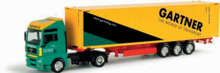
45ποδο container High Cube (μεταφέρεται με πλατφόρμα 40ποδων)
