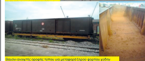
Βαγόνι ανοικτής οροφής τύπου V για μεταφορά ξηρού φορτίου χυδών
