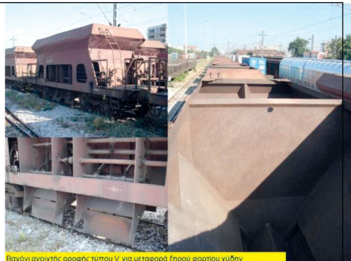
Βαγόνι ανοικτής οροφής τύπου V για μεταφορά ξηρού φορτίου χυδών
