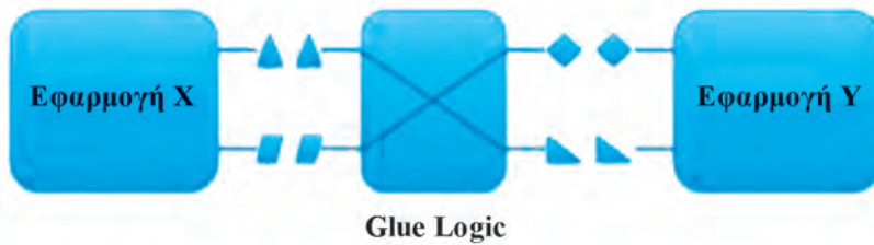
Εικόνα 4 Θέση κυκλώματος συνδετικής λογικής
