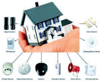
Εικόνα 2: Ολοκληρωμένο σύστημα συναγερμού
