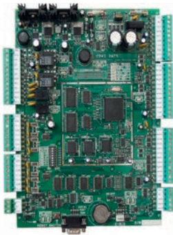
Εικόνα 30: Κεντρική μονάδα Access Control
