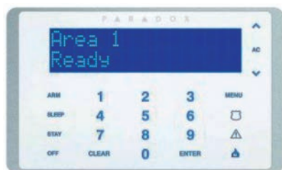
Εικόνα 9: Κεντρική μονάδα- Πληκτρολόγιο με οθόνη υγρών κρυστάλλων οπτικοποίηση των κινήσεών μας.
