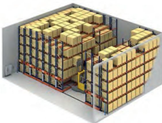
Εικόνα 9.14: Λειτουργία κινητών ραφιών
