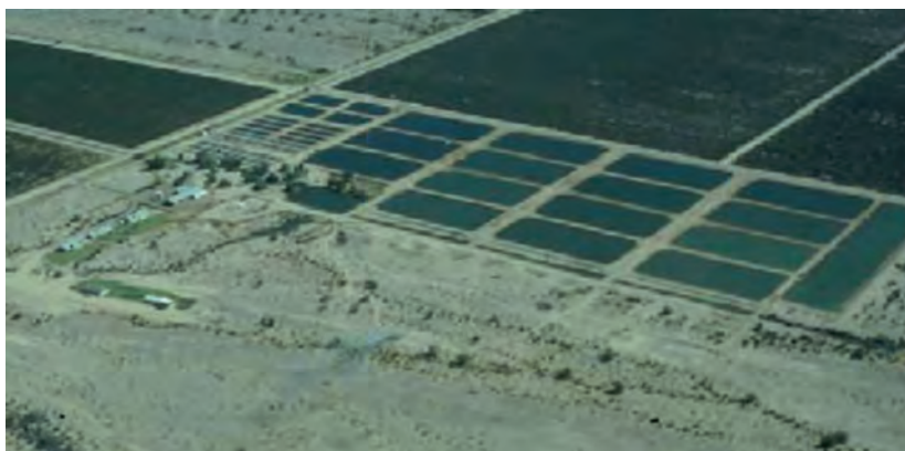
Εικόνα 8.6. Αεροφωτογραφία μονάδας εκτροφής κεφάλου. Διακρίνονται οι χωμάτινες υδατοσυλλογές για την υποδοχή των ιχθυδίων, την προπάχυνση και την πάχυνση σε διαφορετικά μεγέθη.
