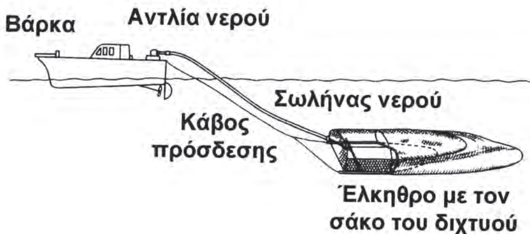
Εικόνα 11.14. Σχηματική παράσταση του τρόπου αλίευσης γαρίδων με τη χρήση ελκήθρου που σύρεται από πλωτό σκάφος.
