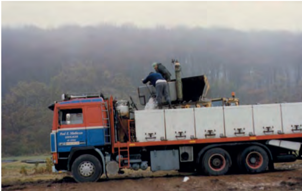
Εικόνα 5.14. Δεξαμενές μεταφοράς στην καρότσα φορτηγού. Διακρίνεται η φιάλη του οξυγόνου.
