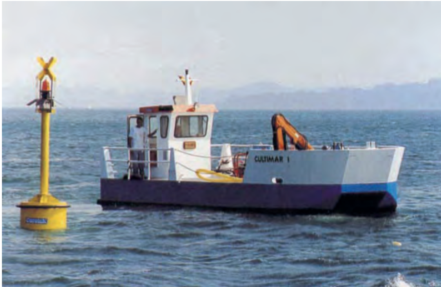
Εικόνα 5.17. Βοηθητικό σκάφος εργασίας με γερανό ενώ περνά το φωτοσημαντήρα της μονάδας.
