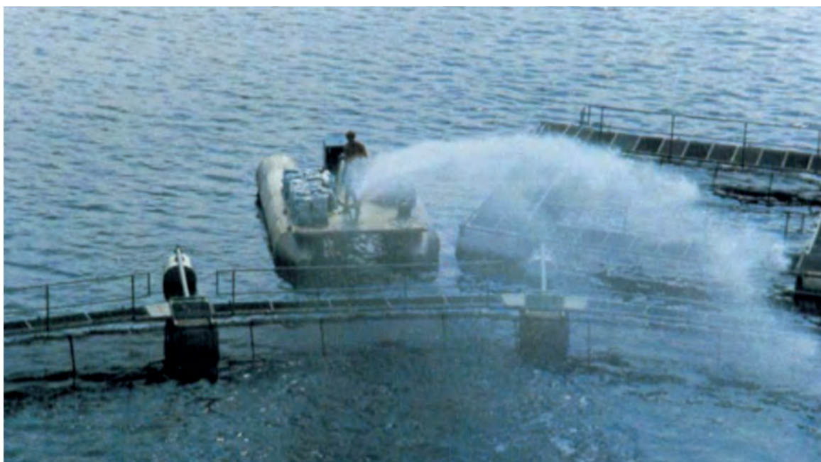
Εικόνα 5.24 Διανομή τροφής από πλωτό σκάφος με τη βοήθεια αυτόνομης συσκευής.
