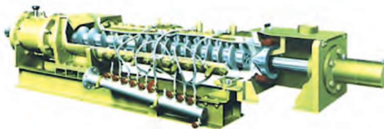
Εικόνα 12.7. Σύγχρονος εξωθητής μείγματος για την παρασκευή των συμπήκτων, μορφής expander ή extruder. Στο εσωτερικό του θερμαίνεται, πιέζεται και εξωθείται το μείγμα της ιχθυοτροφής για την παρασκευή των συμπήκτων (pellets).
