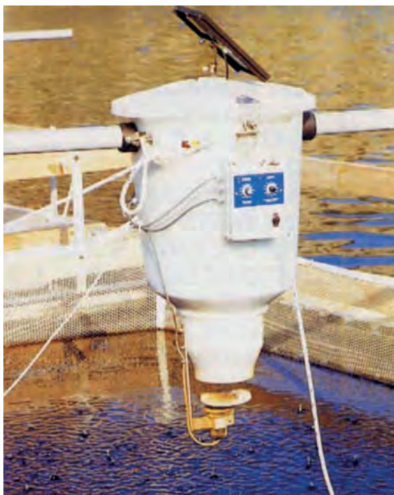
Εικόνα 5.22. Αυτόματη ταΐστρα που λειτουργεί με φωτοκύτταρο. Στο άνω μέρος διακρίνεται ο συλλέκτης ηλιακής ενέργειας.
