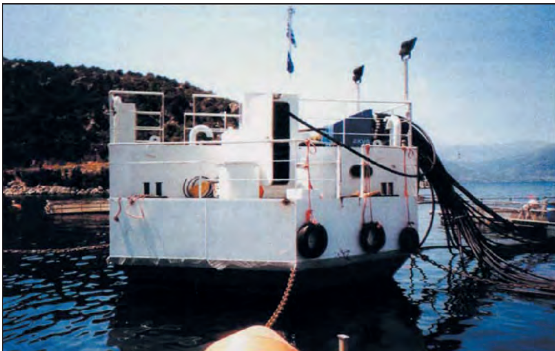
Εικόνα 5.23 Πλωτή μονάδα αποθήκευσης και παροχής τροφής (συμπήκτων). Διακρίνονται οι πλαστικοί σωλήνες μέσω των οποίων διοχετεύονται τα συμπηκτα στους κλωβούς εκτροφής.
