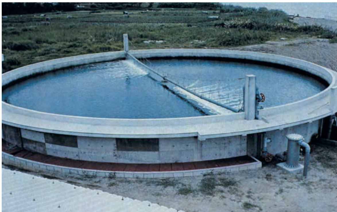
Εικόνα 11.10. Τσιμεντένια κυκλική δεξαμενή τύπου Shiqueno με διπλό πυθμένα για την εντατική εκτροφή της γιαπωνέζικης γαρίδας ( Marsupenaeus japonicus ) ή και της δικής μας γάμπαρης Melicertus kerathurus .
