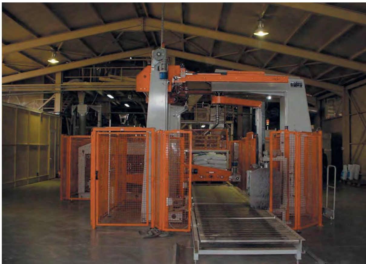
Εικόνα 12.10. Μηχανή συσκευασίας συμπύκτων σε σάκους και στη συνέχεια σε παλέτες.
