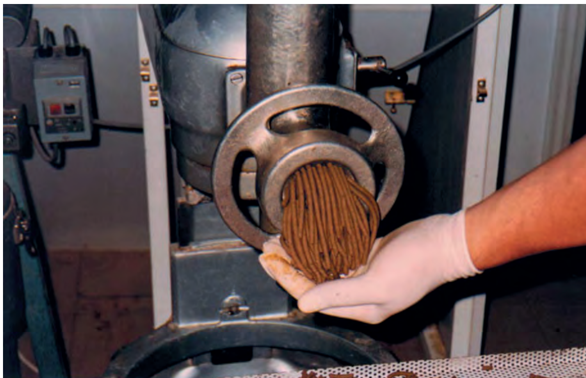
Εικόνα 12.8. Διάτρητη μήτρα που δίνει την τελική μορφή στα σύμπηκτα (pellets).
