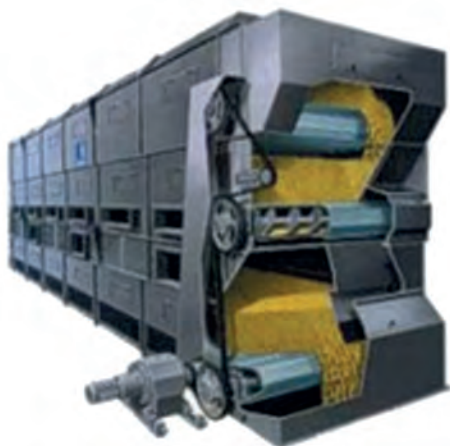
Εικόνα 12.9. Μηχάνημα ξήρανσης ιχθυοτροφής (αριστερά) και ηλεκτρονική ζυγαριά συνεχούς ζυγίσματος πρώτων υλών (δεξιά).
