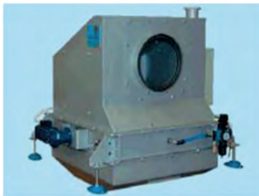
Εικόνα 12.9. Μηχάνημα ξήρανσης ιχθυοτροφής (αριστερά) και ηλεκτρονική ζυγαριά συνεχούς ζυγίσματος πρώτων υλών (δεξιά).
