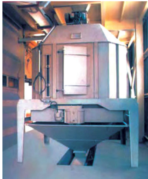
Εικόνα 3.7: Σύστημα ψύξης συμπήκτων
