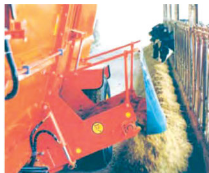
Εικόνα 5.7: (αριστερά) Αυτοκινούμενος αναμκτήρας που ανακατεύει ενσίρωμα με ΣΖ και (δεξιά) διανομή του μείγματος στις ταγίστρες
