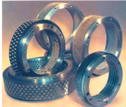
Εικόνα 3.6: Πρέσα (αριστερά) και μήτρες με τρύπες διάφορων διαμέτρων (δεξιά).
