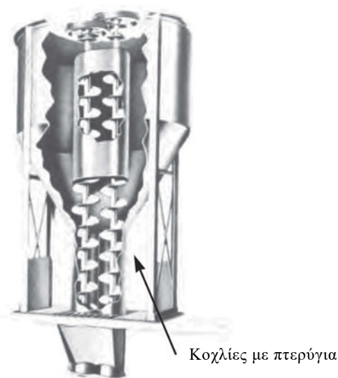
Εικόνα 2.19: Εσωτερική όψη αναμικτήρα
