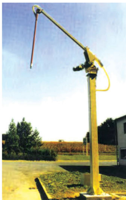
Εικόνα 3.13: Διάφοροι δειγματολήπτες για δειγματοληψία από σακιά (αριστερά) και φορτηγά (δεξιά)
