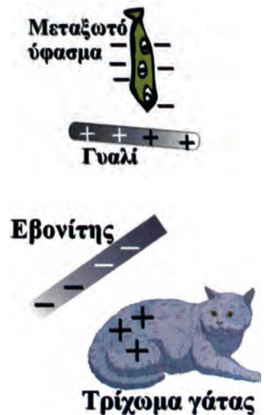
Ηλεκτρίση με τριβή. Εικόνα 4.
