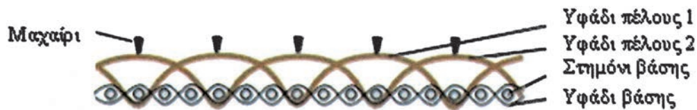
Εικόνα 6.7: Σχηματισμός κομμένου πέλους στα μονά βελούδα υφαδιού
