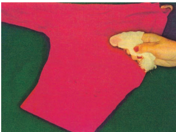
Εικόνα 4.4: Εμπειρική μέθοδος της αντοχής των χρωματισμών στην τριβή
