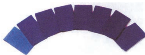
Εικόνα 4.5: SDC πρότυπα μπλε υφάσματος για τη βαθμολόγηση της αντοχής στο φως με την πρότυπη μέθοδο ελέγχου
