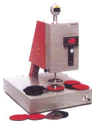
Εικόνα 2.5. Συσκευή προσδιορισμού του πάχους υφάσματος
