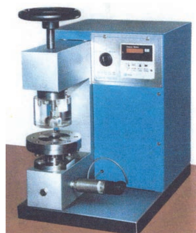
Εικόνα 3.3. Συσκευή προσδιορισμού της αντοχής του υφάσματος στη διάρρηξη (bursting strength tester)
