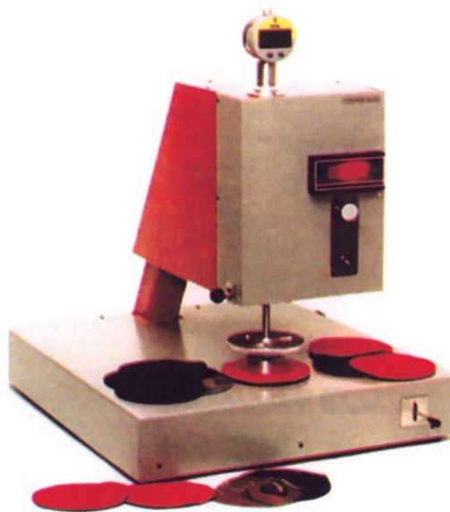
Εικόνα 2.19: Συσκευή προσδιορισμού του πάχους υφάσματος
