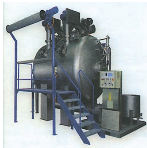
Εικόνα 4.2: Βιομηχανική μηχανή βαφής και φινιρίσματος
