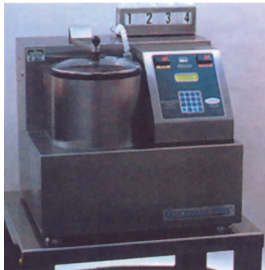
Εικόνα 4.13: Εργαστηριακό πλυντήριο για τις σύγχρονες δοκιμές πλυσίματος
