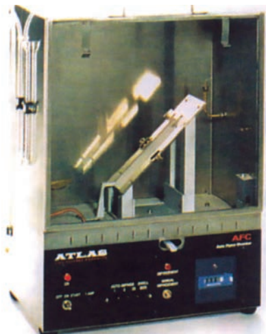
Εικόνα 4.22: Συσκευή για τη μέτρηση της βραδυφλεγίας
