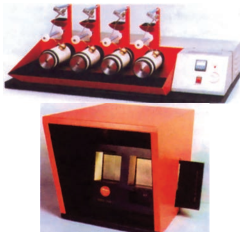
Εικόνα 3.7: Συσκευή I.C.I. Snagg tester, για τον προσδιορισμό της αντοχής του υφάσματος στο ξέφτισμα «Snagging»
