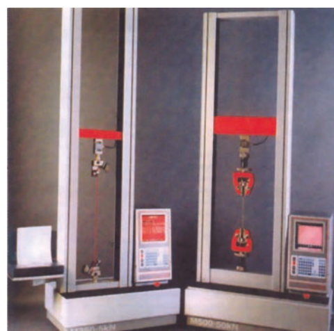
Εικόνα 2.13: Συσκευή προσδιορισμού της αντοχής του νήματος στον εφελκυσμό - Δυναμόμετρο
