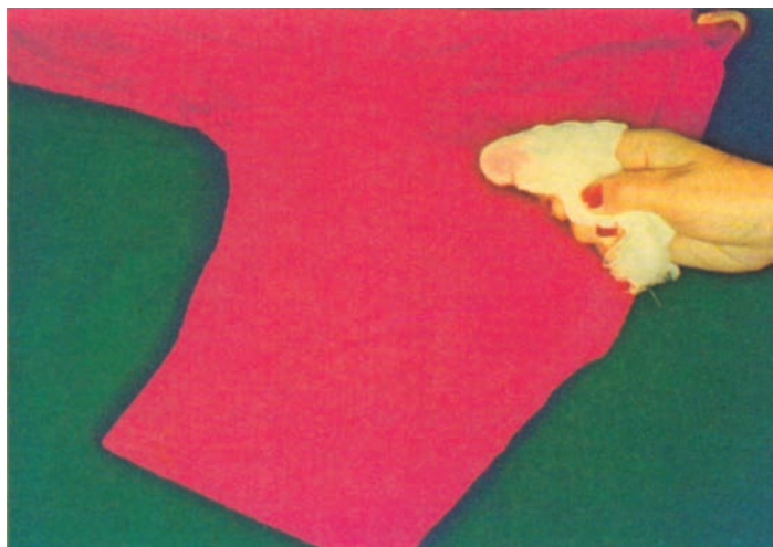
Εικόνα 4.15: Παράδειγμα όπου το ύφασμα μιας μπλούζας με χαμηλή αντοχή χρώματος στην υγρή τριβή λεκιάζει έναν δοκιμαστικό βαμβακερό μάρτυρα
