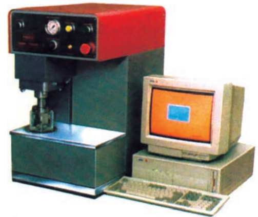
Εικόνα 3.4: Ηλεκτρονική συσκευή bursting strength tester για τον προσδιορισμό της αντοχής του υφάσματος στη διάρρηξη
