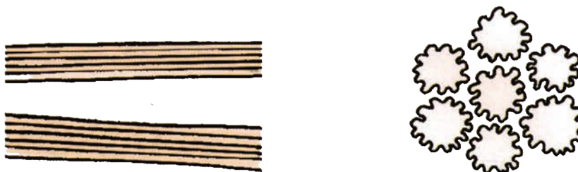
Εικόνα 2.5: Διαμήκης εμφάνιση και εγκάρσια τομή της ίνας βισκόζης
