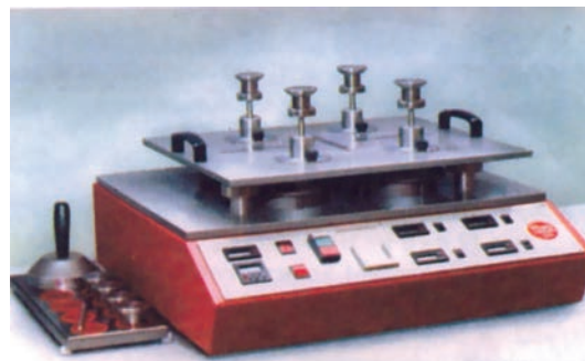
Εικόνα 3.17: Συσκευή Martindale tester, για τον προσδιορισμό της αντοχής του υφάσματος στην τριβή
