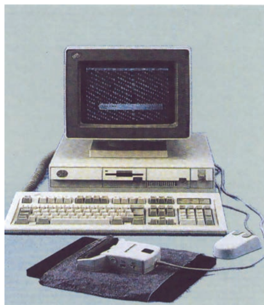
Εικόνα 2.23: Ηλεκτρονικό σύστημα προσδιορισμού της πυκνότητας των υφασμάτων (σαρωτής υφασμάτων)
