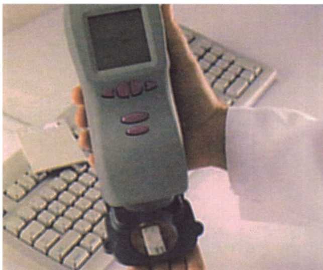
Εικόνα 5.10: Φορητό φασματοφωτόμετρο ανάκλασης
