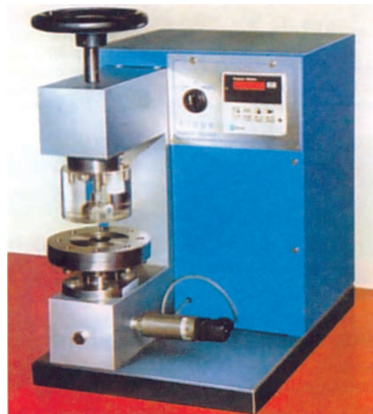
Εικόνα 3.16: Συσκευή προσδιορισμού της αντοχής του υφάσματος στη διάρρηξη (bursting strength tester)
