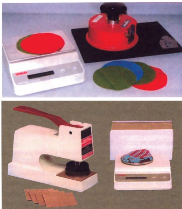
Εικόνα 2.20: Όργανο κοπής υφάσματος για τον προσδιορισμό του βάρους και ηλεκτρονικός ζυγός
