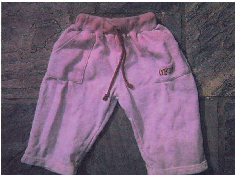
Εικόνα 4.4: Το συγκεκριμένο παιδικό παντελονάκι είναι φτιαγμένο από ύφασμα που ανταποκρίνεται στις βασικές προδιαγραφές πλυσίματος για τη χρήση του. Ωστόσο, δεν συνέβαινε το ίδιο και με το κορδόνι που χρησιμοποιήθηκε στη μέση. Το αποτέλεσμα ήταν να καταστραφεί το παντελονάκι με το πρώτο πλύσιμο
