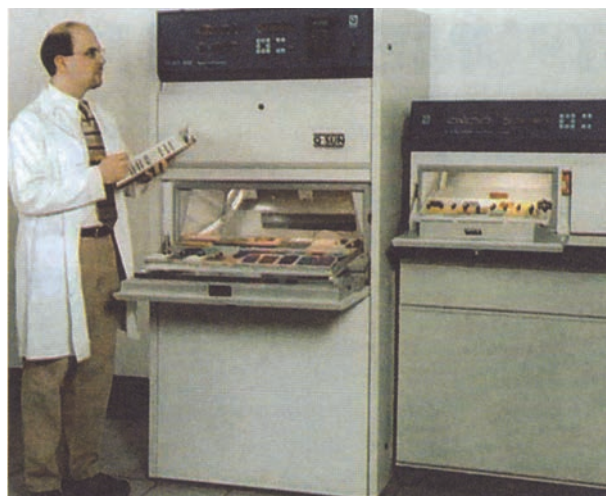
Εικόνα 4.20: Μηχάνημα για τη μέτρηση της αντοχής στο φως
