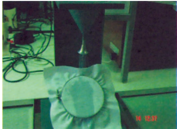
Εικόνα 3.12: Σύσκευή «Spray rating tester» για τον προσδιορισμό της διαβρεκτικότητας υφάσματος
