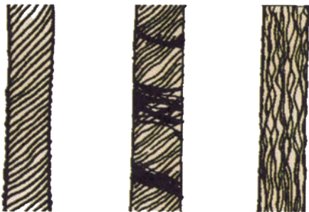
Εικόνα 2.9: α. Νήμα συμβατικής νηματοποίησης β. Νήμα ανοικτού άκρου με ρότορα γ. Νήμα τεξτουρέ
