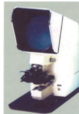
Εικόνα 2.10: Συσκευή μικροσκοπίου προβολής για τον προσδιορισμό του τύπου των ινών και των νημάτων
