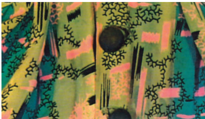
Εικόνα 4.19: Δείγμα φορέματος όπου το μπλε χρώμα που χρησιμοποιήθηκε στη βαφή του δεν είχε τις απαιτούμενες αντοχές στο φως, με συνέπεια, όπου δεν υπήρχε φυσική προστασία λόγω των τσακίσεων, να αποχρωματιστεί
