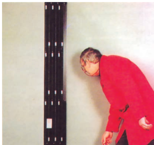
Εικόνα 2.25: Συσκευή μέτρησης μήκους νήματος σειράς πλεκτού υπό ορισμένη τάση
