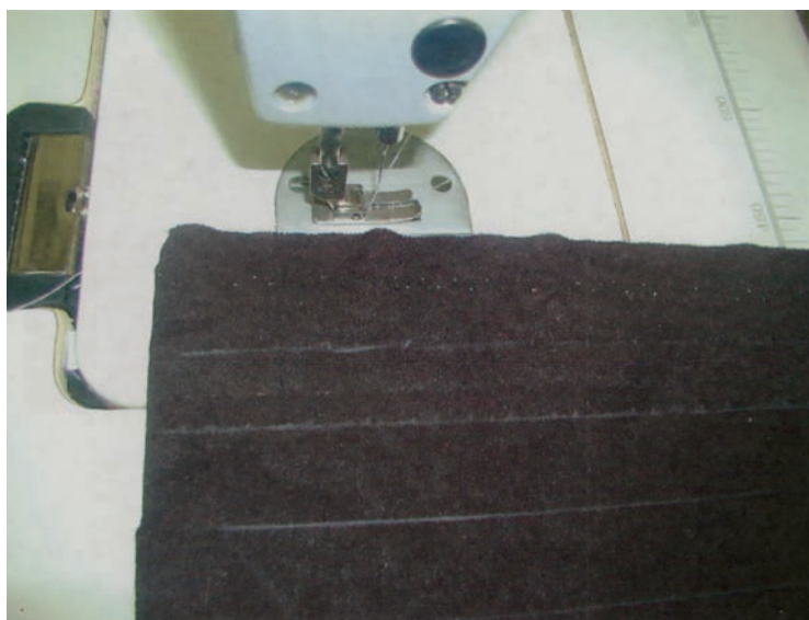
Εικόνα 3.68: Τοποθέτηση της φλιζελίνης στην πλάκα της μηχανής
