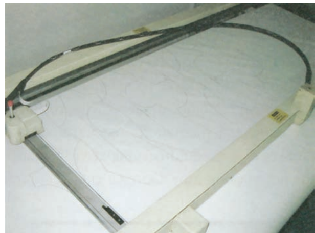
Εικόνα 1.13: Plotter για την εκτύπωση του πατρών
