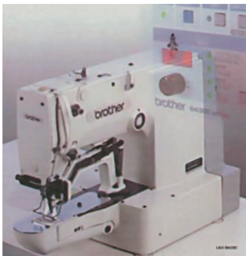
Εικόνα 3.72: Μηχανή για πονταρισιά
