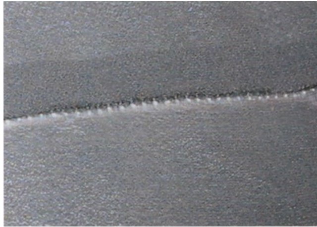
Εικόνα 4.3: Τραυματισμός του υφάσματος από ακατάλληλη βελόνα
