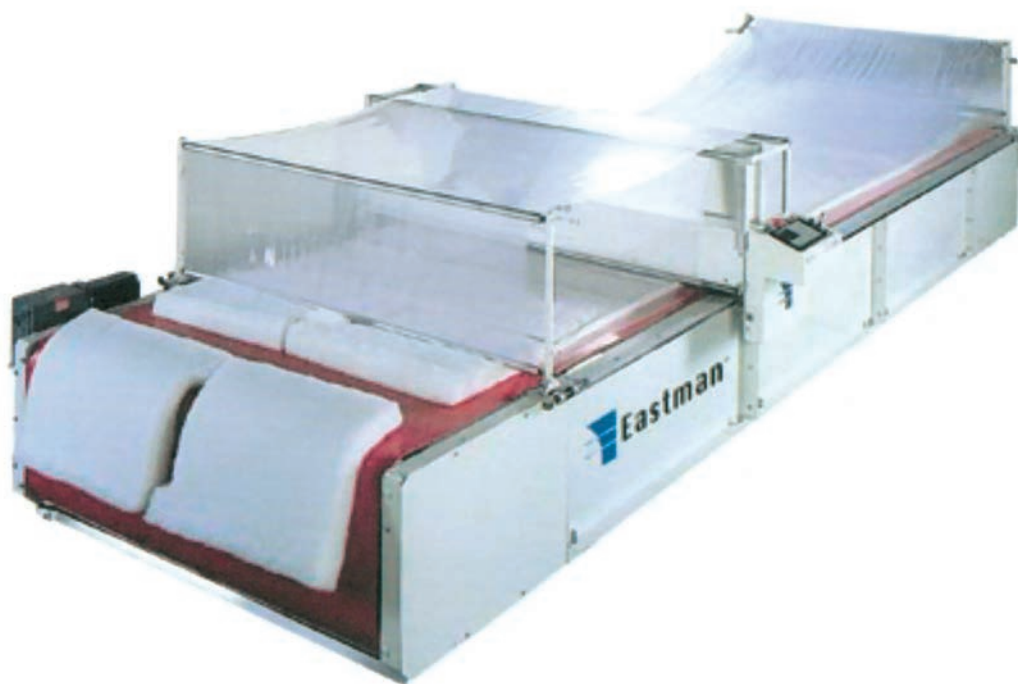
Εικόνα 2.18: Μηχανισμός αναρρόφησης με μεμβράνη πολυαιθυλενίου
