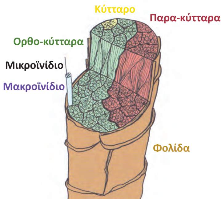
Εικόνα 3.6 Σχηματικό διάγραμμα της δομής μάλλινης ίνας
