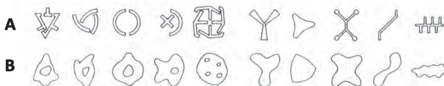
Εικόνα 4.2 (Α) Σχήματα οπών φιλιέρας και (Β) τα αντίστοιχα σχήματα διατομών των παραγόμενων ινών
