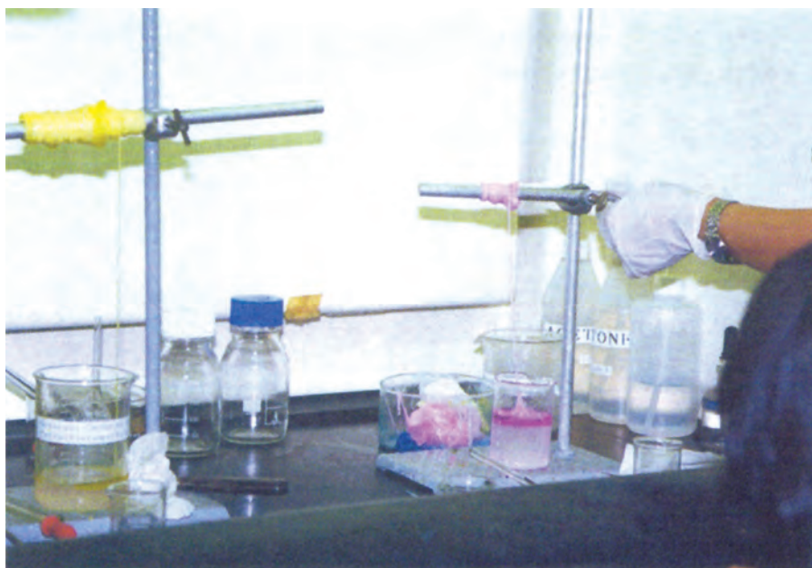
Εικόνα 5.2 Εργαστηριακή αναπαράσταση του σχηματισμού ινών νάιλον
