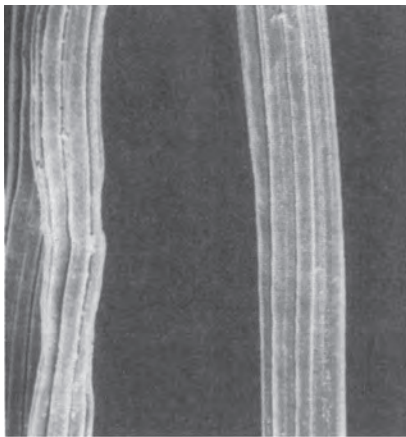
Εικόνα 1.18 Ίνα βισκόζης: (α) κατά μήκος, (β) διατομή
