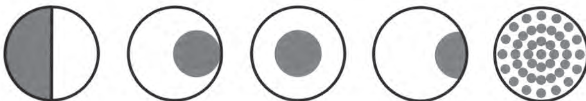
Εικόνα 1.1 Διάταξη των δύο πολυμερών σε διατομή διμερών ινών
