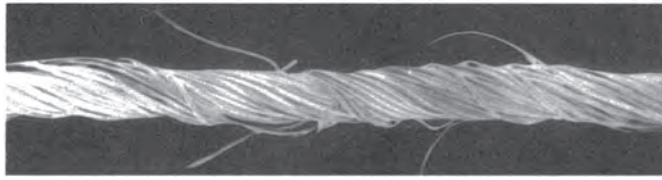
Εικόνα 6.15 Νήμα περιελιγμένων ινών (Air-jet)
