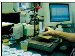
Εικόνα 4-6: Μέτρηση του pH με ηλεκτρονικό πεχάμετρο.
