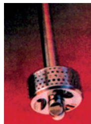
Εικόνα 2-8: Λεπτομέρεια από άκρο ομογενοποιητή (ρότορας-στάτορας).
