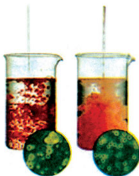
Εικόνα 2-13: Σύγκριση των δυο τύπων γαλακτωμάτων: water in oil (w/o, αριστερά) και oil in water (o/w, δεξιά).
