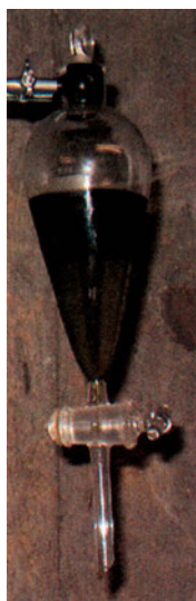
Εικόνα 1-12: Διαχωριστική χοάνη για εκχύλιση δυο υγρών που δεν αναμιγνύονται.
