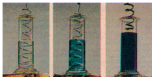
Εικόνα 5-1: Οξειδοαναγωγική αντίδραση χαλκού (Cu) με ιόντα αργύρου ( \text{Ag}^+ ):
