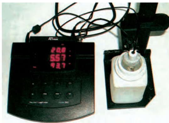
Εικόνα 4-5: Ηλεκτρονικό πεχάμετρο με αισθητήρα θερμοκρασίας και buffer για ρύθμιση της συσκευής.
