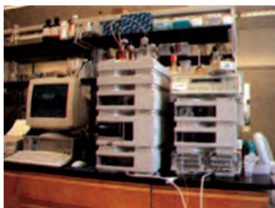
Εικόνα 1-16: Συσκευή υγρής χρωματογραφίας HPLC.
