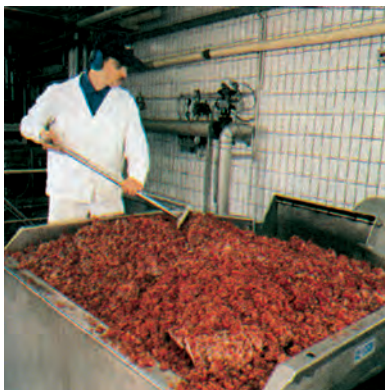
Εικόνα 14-4: Προετοιμασία εκχύλισης λουλουδιών για την βιομηχανική παραγωγή αρωματικών και χρωστικών πρώτων υλών.
