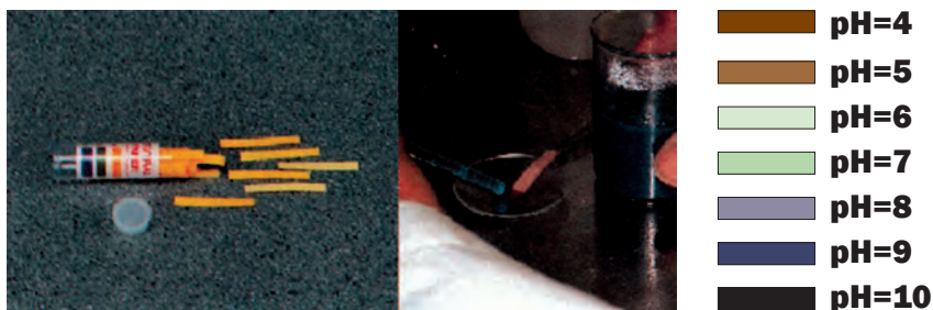
Εικόνα 4-4: Πεχαμετρικό χαρτί (αριστερά), ο τρόπος χρήσης του (μέσον) και η χρωματική κλίμακα εύρεσης τιμών pH (δεξιά).
