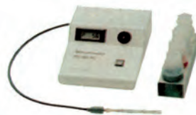
Εικόνα 4-2: Συσκευή προσδιορισμού pH του δέρματος.
