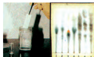
Εικόνα 1-15: Ανάπτυξη χρωματογραφήματος TLC.
