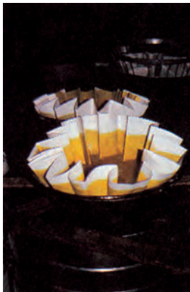
Εικόνα 1-18: Διήθηση εκχυλίσματος σε βιομηχανική κλίμακα (εργοστάσιο παραγωγής αρωματικών πρώτων υλών από φυτά).
