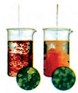
Εικόνα 2-13: Σύγκριση των δυο τύπων γαλακτωμάτων: water in oil (w/o, αριστερά) και oil in water (o/w, δεξιά).
