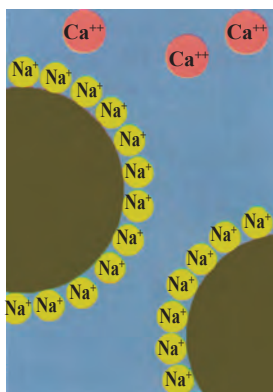
Εικόνα 11-2: Η λειτουργία μιας ιονανταλλακτικής (κατιονικής) ρητίνης.
