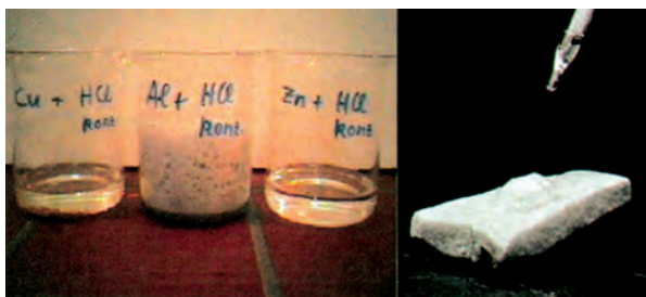
Εικόνα 3-5: Αντίδραση διαλύματος HCl με χαλκό, αργίλιο, ψευδάργυρο και με ασβεστόλιθο (από αριστερά προς τα δεξιά). Σχηματισμός αφρισμού από το παραγόμενο διοξείδιο του άνθρακα ( \text{CO}_2 ).
