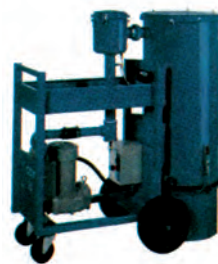
Εικόνα 18-2: Συσκευή με κενό και φίλτρα για την παραγωγή πούδρας σε συμπαγή (compact) μορφή.
