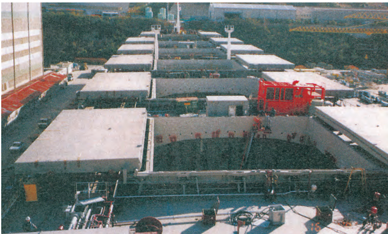
Φωτογραφία 1.2: Ανοίγματα κυτών του πλοίου μεταφοράς χύμα φορτίων της φωτογραφίας 1
