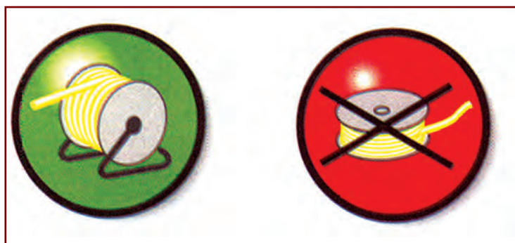
Σχήμα 6.2: Σωστό και λανθασμένο ξετύλιγμα καλωδίων.
