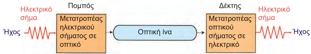
Σχήμα 3.13: Σύστημα μεταφοράς φωνής με οπτική ίνα.
