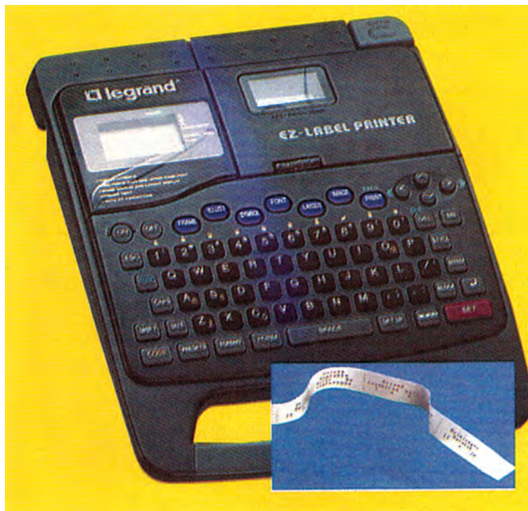
Σχήμα 6.6: Ηλεκτρονικό πληκτρολόγιο τίτλων για την τακτοποίηση κυκλωμάτων.
