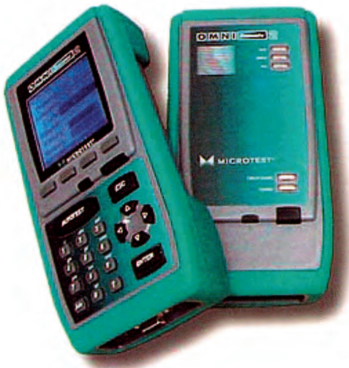
Σχήμα 6.7: Το όργανο ελέγχου πεδίου OMNISCANNER2 της εταιρείας MICROTEST, για πιστοποιήσεις καλωδιώσεων κατηγορίας 5/5E/6/7 έως 300 MHz.
