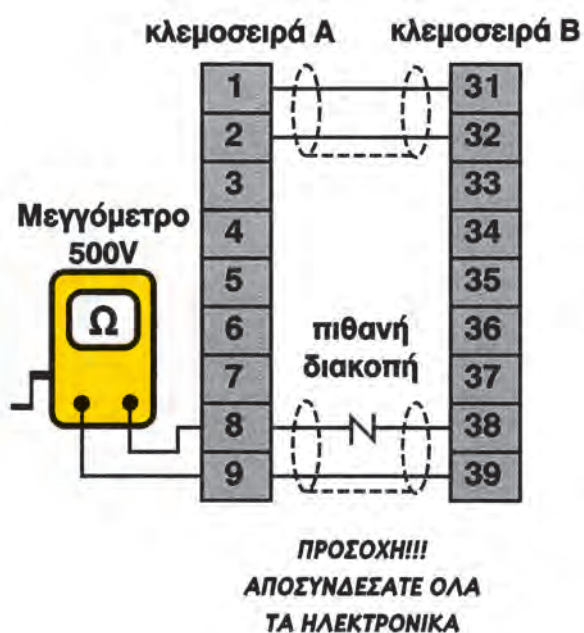
Σχήμα 24.15(β): Ανίχνευση πιθανής διακοπής με μεγγερόμετρο
