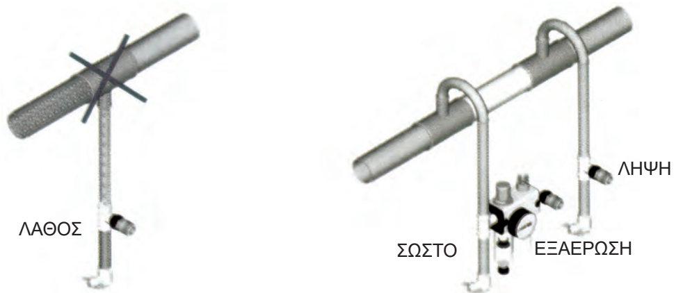
Σχήμα 14.2: Τρόπος λήψης παροχών από σωλήνες δικτύου αέρος
