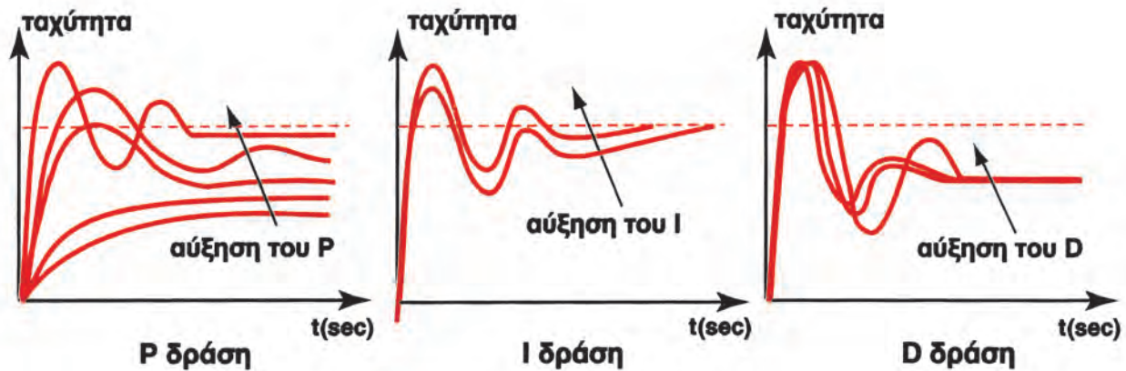
Σχήμα 24.2: Βηματική απόκριση εξόδου συστήματος (όχι εξόδου ελεγκτή) και επιλογή P, I, D δράσεων
