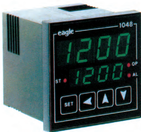
Σχήμα 24.1(α): Σύγχρονος ψηφιακός PID ελεγκτής
