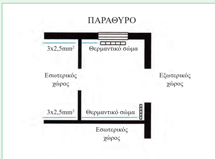
Σχήμα 2.3. Τοποθέτηση των θερμαντικών σωμάτων στην κάτοψη.
