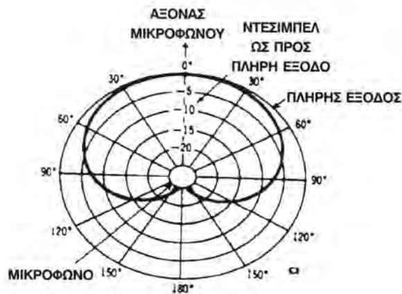
Σχήμα 1.2.1.2 Πολικό διάγραμμα καρδιοειδούς μικροφώνου
