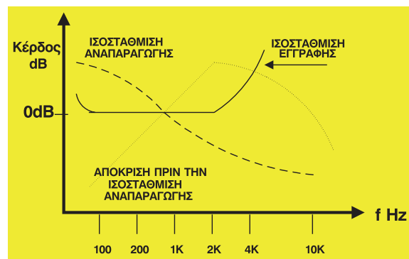
Σχήμα 2.2.2 Διάγραμμα καμπυλών ισοστάθμισης εγγραφής - αναπαραγωγής
