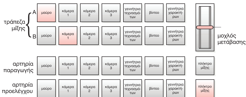
Σχήμα 5.14b Αρτηρία παραγωγής, προελέγχου και τράπεζα μίξης.
