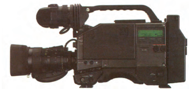
Σχήμα 4.5.1.2 Κάμερα για εφαρμογή ENG
