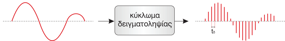
Σχήμα 3.2.1a Δειγματοληψία αναλογικού σήματος
