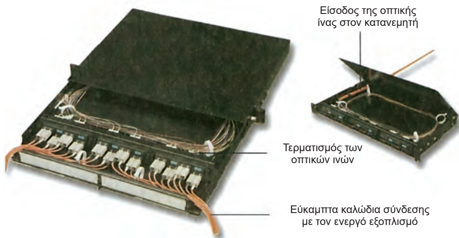
Εικόνα 5-10 Ο οπτικός κατανεμητής. Στο μπροστινό τμήμα του κατανεμητή καταλήγουν οι ίνες, που έχουν εισαχθεί σ' αυτόν. Στην εικόνα φαίνονται τα εύκαμπτα οπτικά καλώδια, τα οποία συνδέονται στις υποδοχές, στην μπροστινή πλευρά του κατανεμητή
