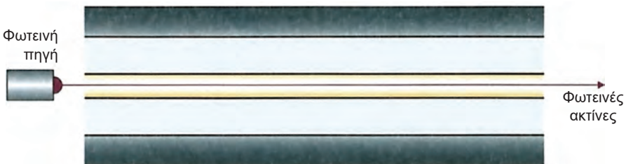
Σχήμα 4-9 Μονότροπη οπτική ίνα (single mode fiber optic)
